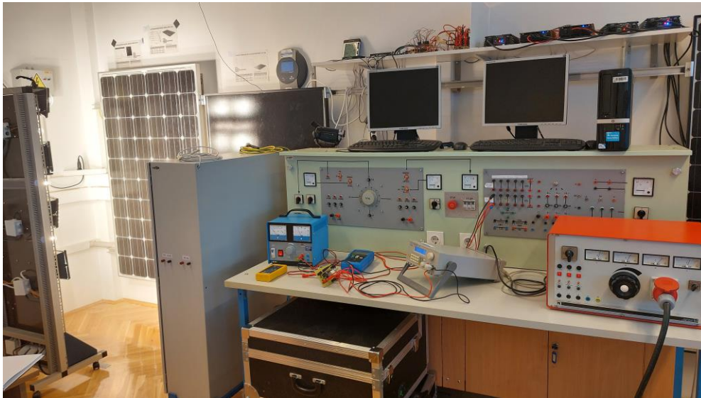
Sl. 5.10. Izvođenje mjerenja određivanja faktora stabilizacije solarnim panelom.
