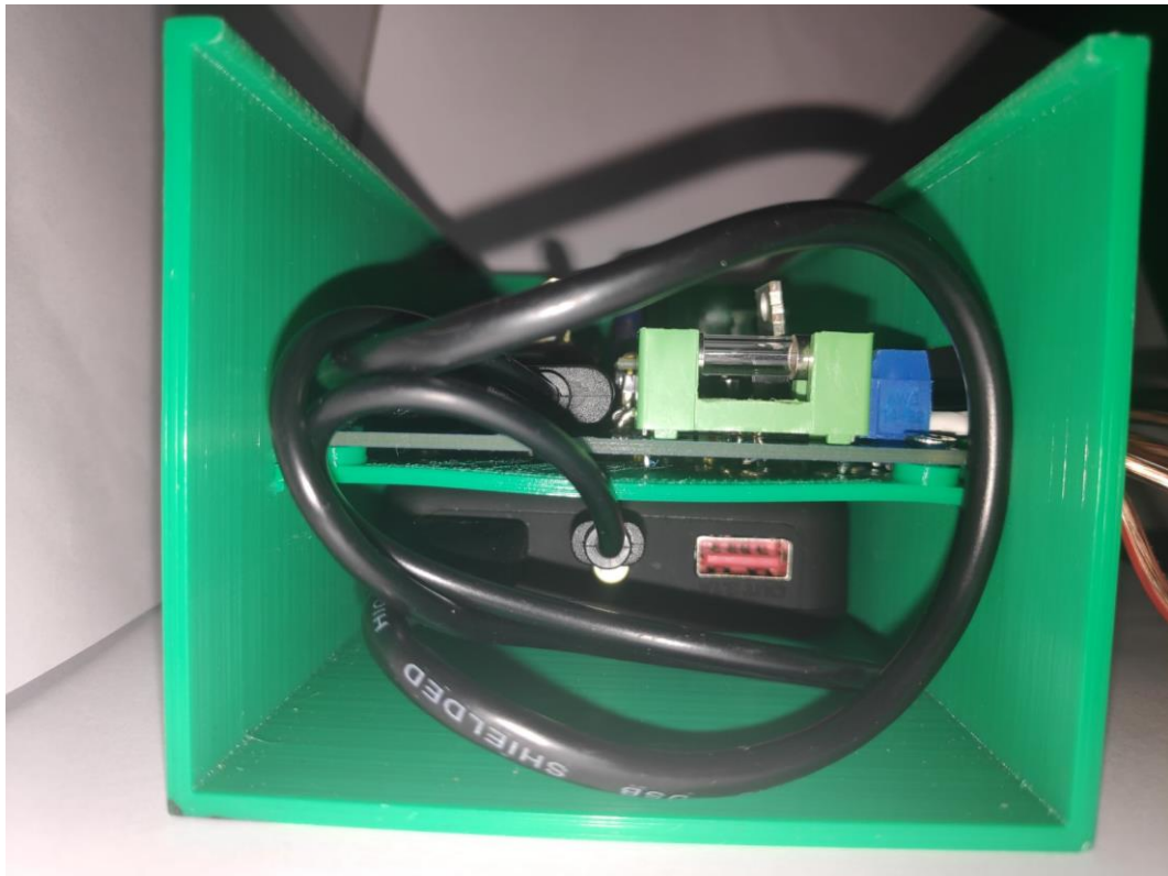
Slika 3.32. Gotov uređaj bez gornjeg i bočnog poklopca – bočni pogled
