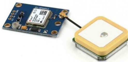
Slika 3.8. NEO-6M GPS modul i antena
