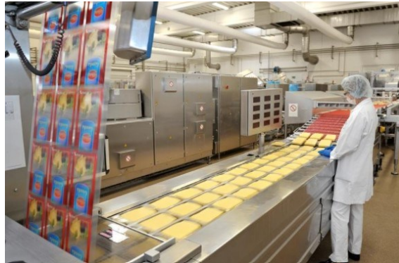
Slika 7.5. Linearni pogon za pakiranje sire u firmi Multisan [15]
