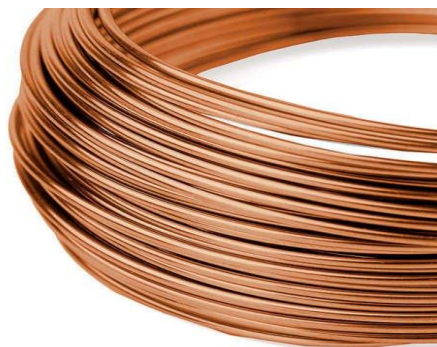
Slika 3.2. Prikaz žice izrađene od manganina
