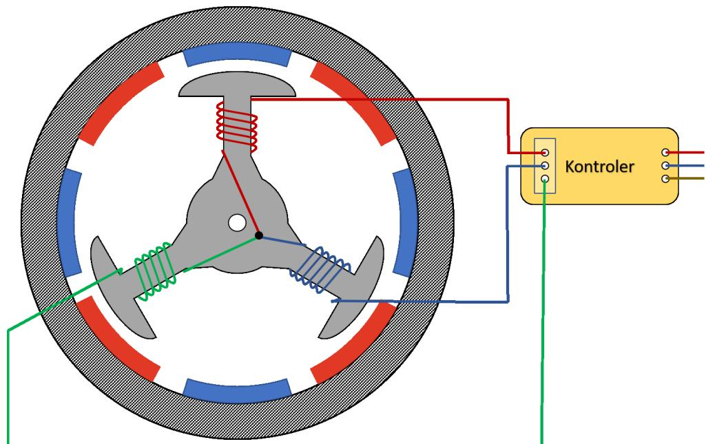
Sl. 3.3. Pojednostavljeni prikaz beskolektorskog istosmjernog motora
