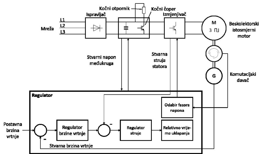
Sl. 5.1. Struktura servopogona sa BLDC motorom [3]
