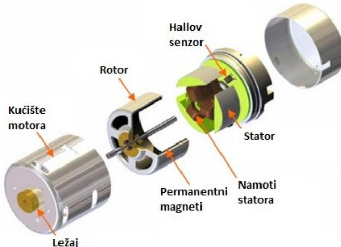
Sl. 4.8. Građa BLDC motora sa vanjskim rotorom [12]
