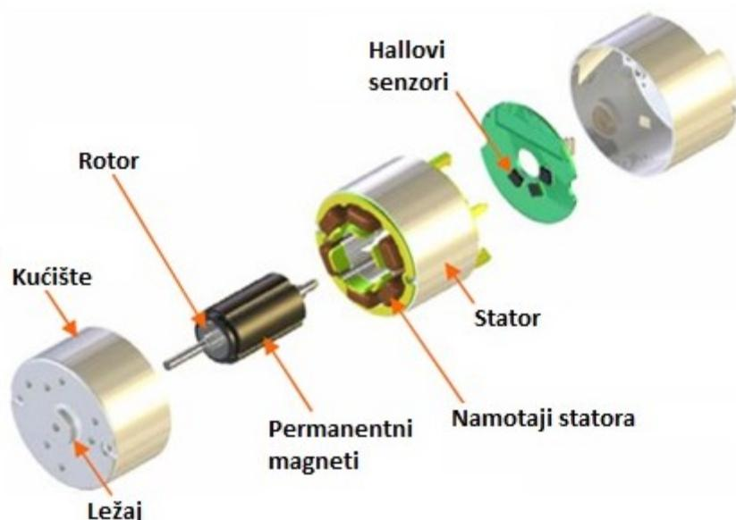
Sl. 4.9. Građa BLDC motora sa unutarnjim rotorom [12]
