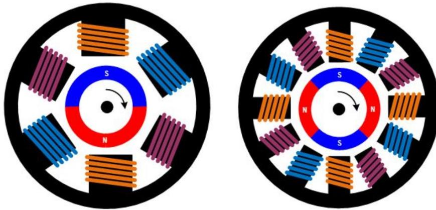
Sl. 4.2. lijevo: 2-polna izvedba, desno: 4-polna izvedba [8]
