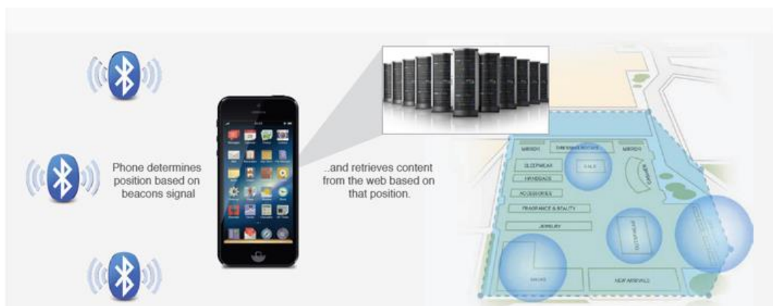
Slika 4.1 Prikaz rada Beacon uređaja [8]
