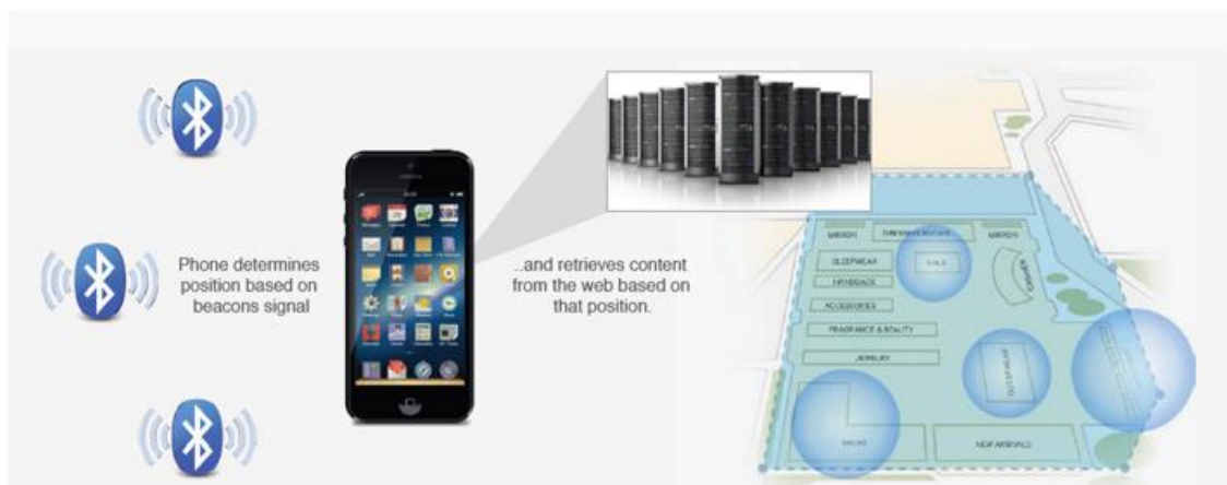
Slika 4.1 Prikaz rada Beacon uređaja [8]
