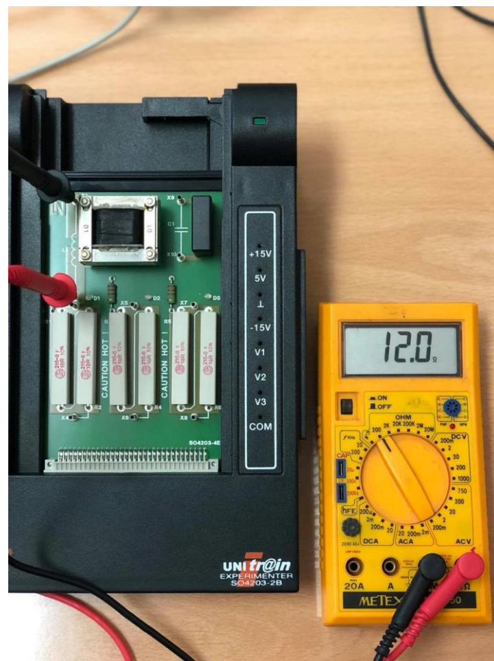
Slika 4.15. Proces određivanja otpornosti prigušnice R
