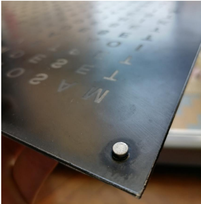
Slika 4.7. Magnet zalijepljen na lice sata.
