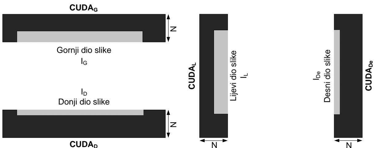
Slika 4.22: Veza između pojedinih CUDA PBSCD kernela ( $CUDA_G$ ,  $CUDA_D$ ,  $CUDA_L$  i  $CUDA_{De}$ ) i dijelova  $I(x, y)$  slike prema izrazu (4.25).
