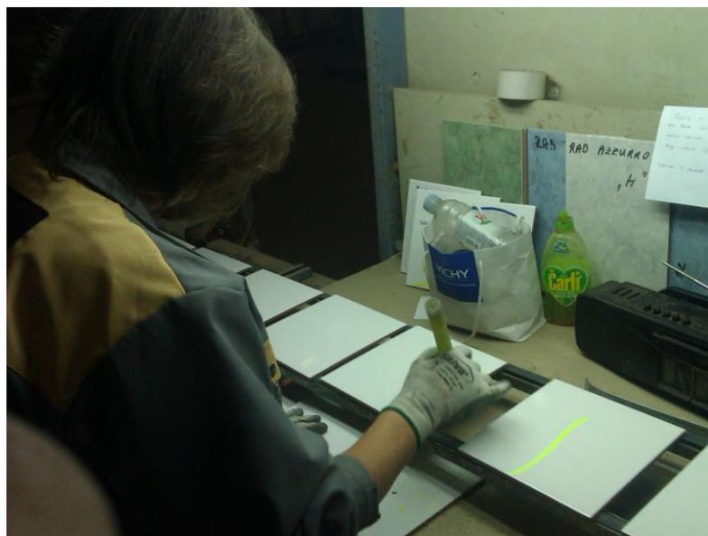
Slika 2.6: Vizualna kontrola kvalitete keramičkih pločica (ustupila Keramika Modus d.o.o.).
