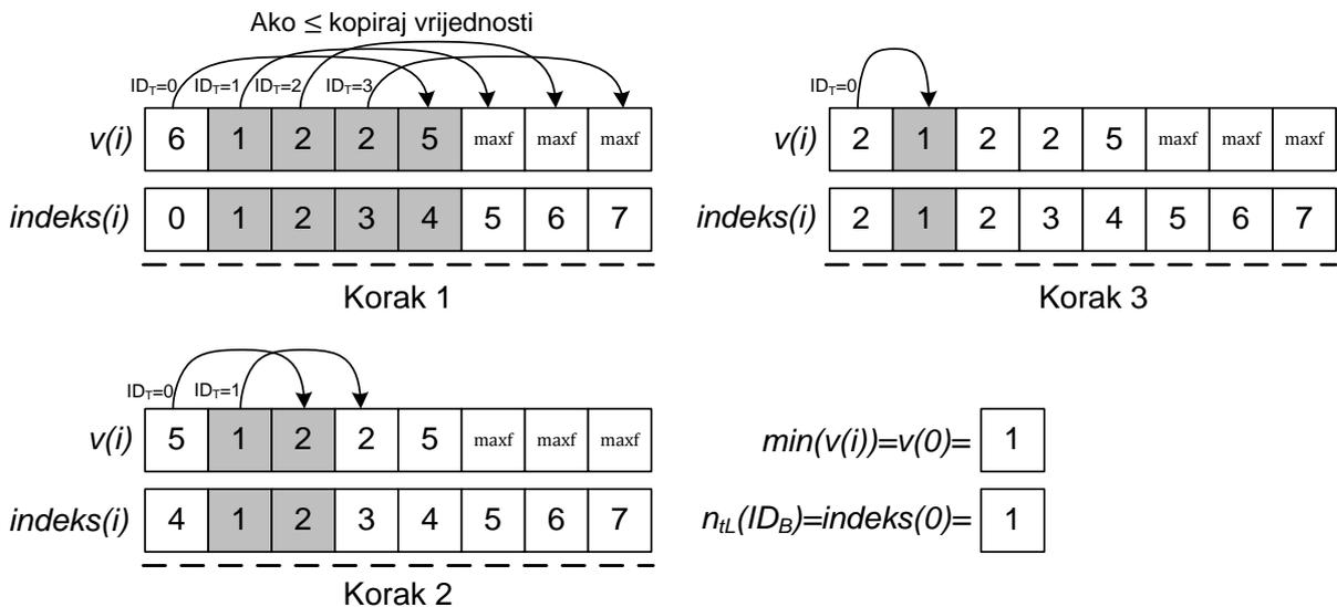
Slika 4.23: Primjer određivanja  $n_{tL}(ID_B)$  za  $N = 6$  upotrebom redukcijuskog algoritma. Sivo obojeni elementi predstavljaju pronađenu manju vrijednost u pojedinom koraku, crtkana linija predstavlja sinkronizacijske točke,  $\text{maxf}$  predstavlja maksimalni broj jednostruke preciznosti.
