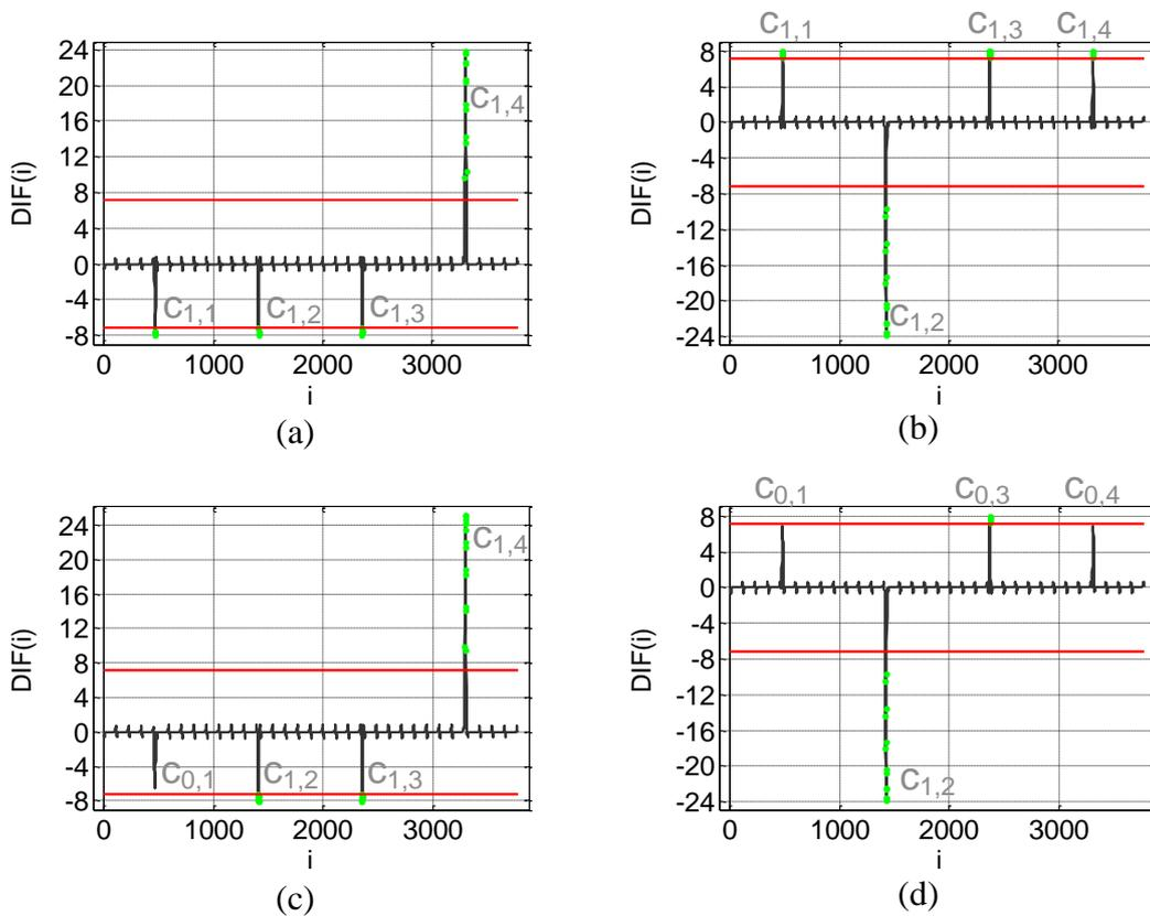
Slika 5.19: Primjer detektiranih grupa točaka  $c_{l,k}$  (označeno sa zelenim točkama) za primjer sa slike 5.8 s početnim smjerom konture (a)  $D(0) = 0^\circ$ , (b)  $D(0) = 180^\circ$  i za primjer sintetički generirane binarne slike s neispravnostima na dva ugla sa početnim smjerom konture (c)  $D(0) = 0^\circ$ , (d)  $D(0) = 180^\circ$  (crvena linija predstavlja  $T_U = 7.2^\circ$ ).
