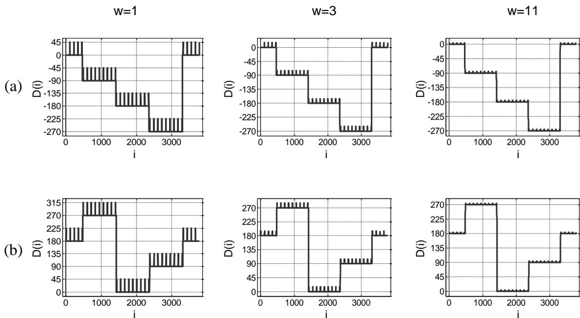
Slika 5.12: Osrednjeni smjer konture s kružnim pomičnim prosjekom širine prozora  $w \in \{1, 3, 11\}$  za sintetički generiranu binarnu sliku sirove pločice s kutom rotacije  $\gamma = 0.5^\circ$  i (a)  $D(0) = 0^\circ$ , (b)  $D(0) = 180^\circ$ .
