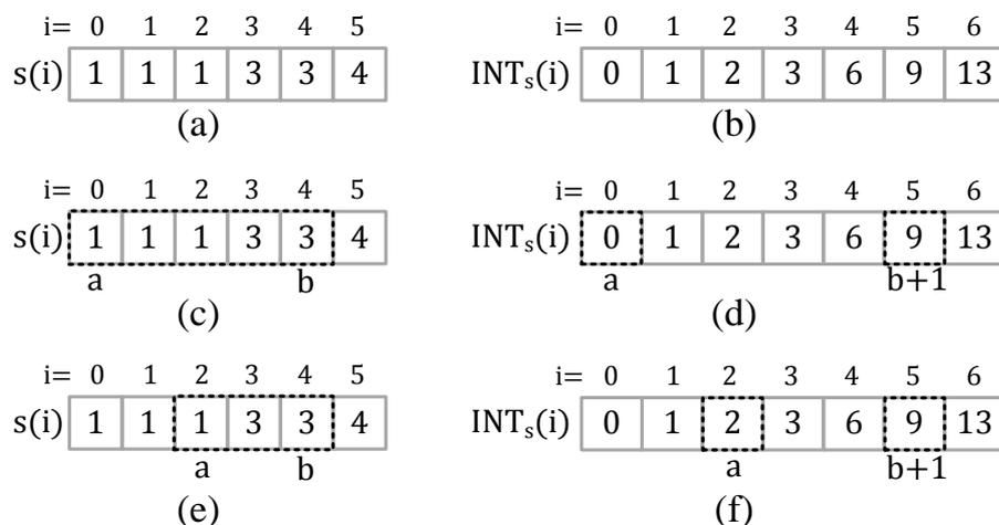
Slika 4.15: Primjer signala  $s(i)$  (a), (b) 1D integralna suma signala  $s(i)$ , (c) i (d) primjer izračuna sume dijela signala za  $a = 0, b = 4$  prema (4.33), (e) i (f) primjer izračuna sume dijela signala za  $a = 2, b = 4$  prema (4.33).
