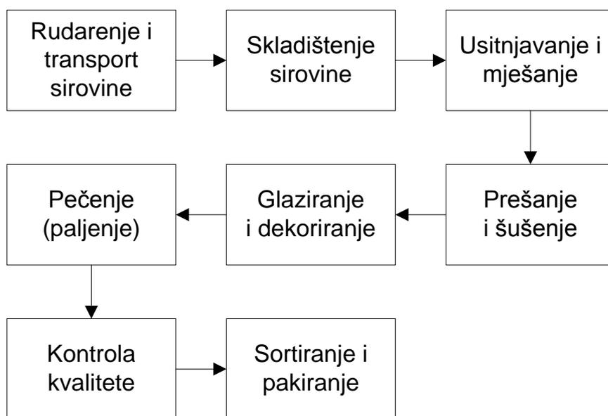
Slika 2.2: Shematski prikaz procesa proizvodnje keramičkih pločica monopaljenjem.
