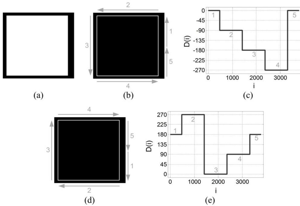
Slika 5.7: Primjer smjera konture: (a) sintetički generirana binarna slika sirove pločice  $I_B(x, y)$  s kutom rotacije  $\gamma = 0^\circ$ , (b) slika ruba  $I_R(x, y)$  s naznačenim smjerom praćenja konture za  $D(0) = 0^\circ$ , (c) graf smjera konture  $D(i)$  za  $D(0) = 0^\circ$ , (d) slika ruba  $I_R(x, y)$  s naznačenim smjerom praćenja konture za  $D(0) = 180^\circ$ , (e) graf smjera konture  $D(i)$  za  $D(0) = 180^\circ$ .
