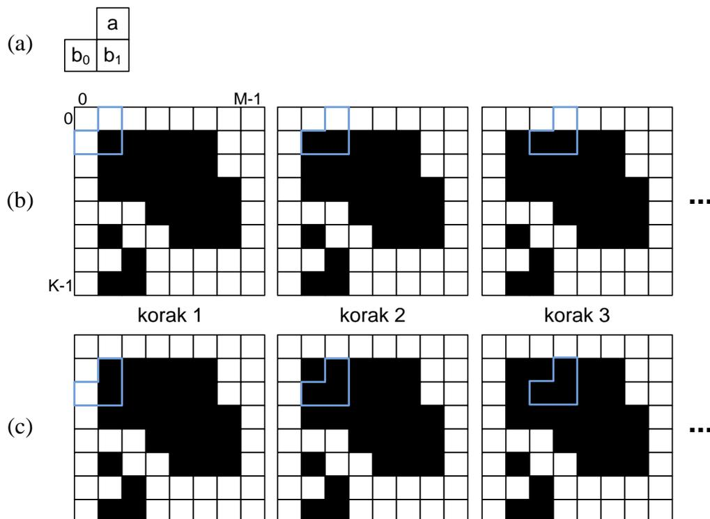
Slika 5.3: Obrnuta  $L$  forma s označenim pikselima (a), (b) prva tri koraka detektiranja točaka ruba za nulti i prvi red slike 5.2 (a), (c) prva tri koraka detektiranja točaka ruba za prvi i drugi red slike 5.2 (a).
