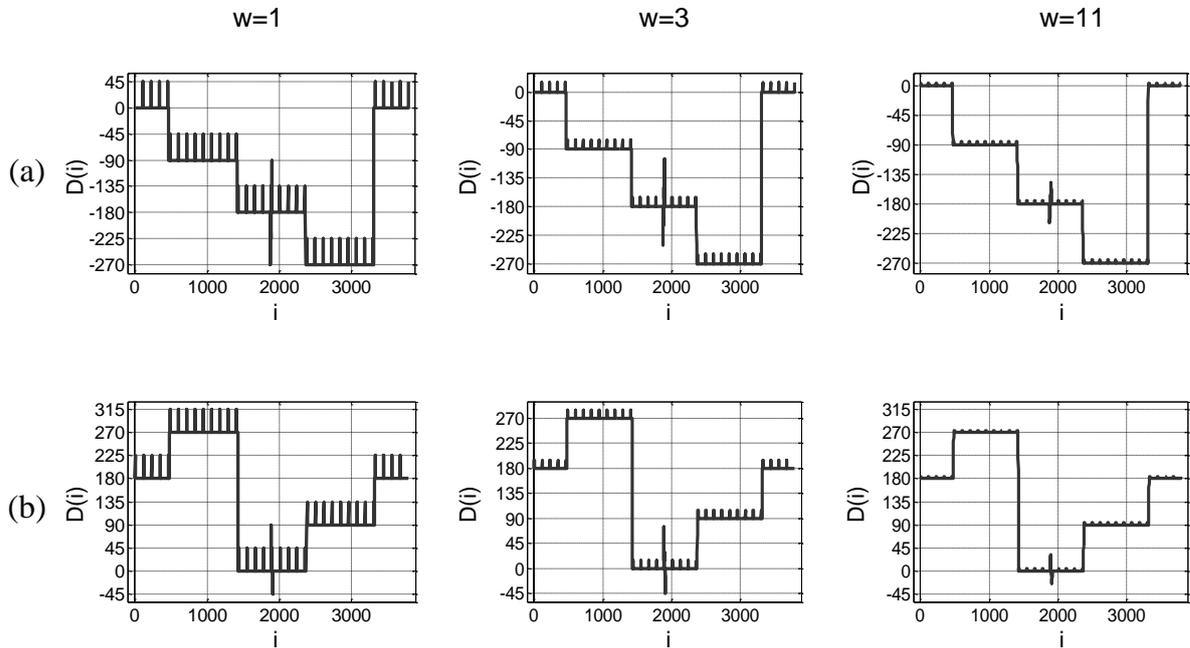
Slika 5.13: Osrednjeni smjer konture s kružnim pomičnim prosjekom širine prozora  $w \in \{1, 3, 11\}$  za sintetički generiranu binarnu sliku sirove pločice s jednom neispravnosti na lijevom rubu, kutom rotacije  $\gamma = 0.5^\circ$  i (a)  $D(0) = 0^\circ$ , (b)  $D(0) = 180^\circ$ .
