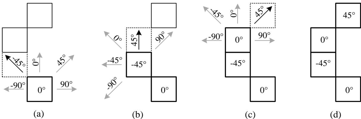
Slika 5.5: Primjer praćenja konture i određivanja smjera konture za četiri točke ruba (a) do (d) i  $D(0) = 0^\circ$ . Pronađena sljedeća točka konture je označena sa crtkanim kvadratom, izračunati  $D(i)$  je upisan u središte kvadrata.
