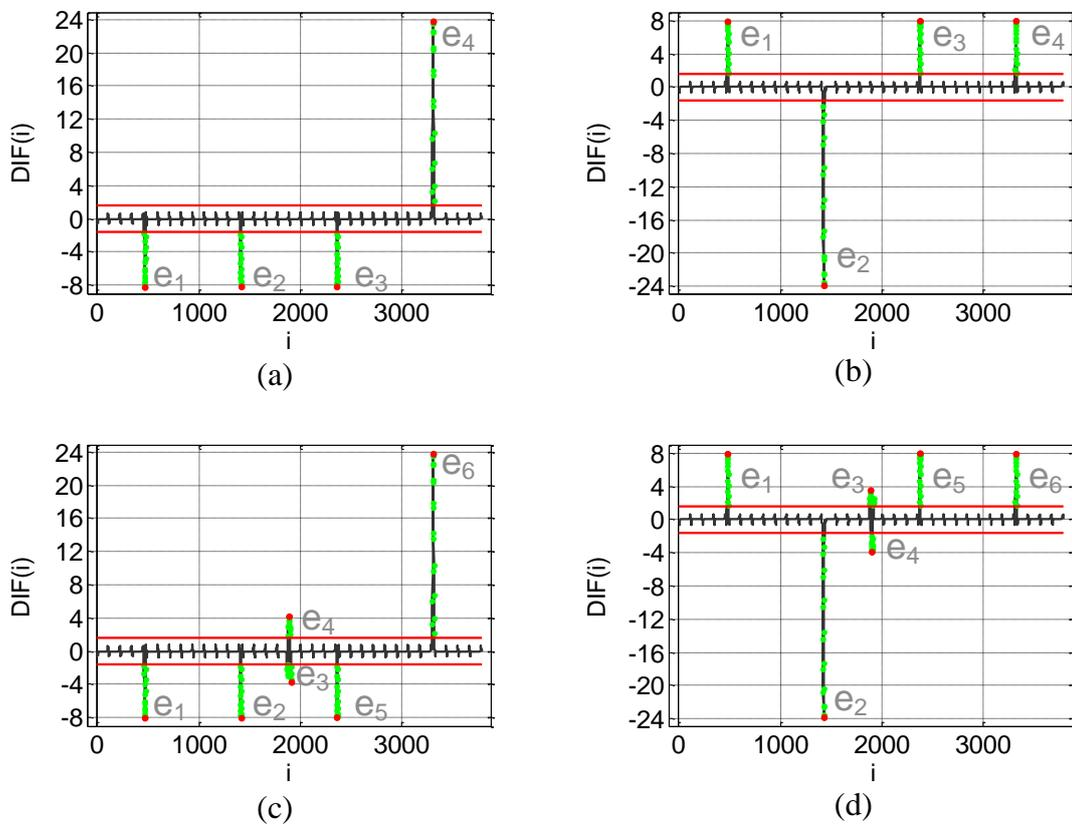
Slika 5.18: Primjer detektiranih grupa točaka  $e_k$  (označeno sa zelenim točkama) za primjer sa slike 5.8 s početnim smjerom konture (a)  $D(0) = 0^\circ$ , (b)  $D(0) = 180^\circ$  i primjer sa slike 5.11 s početnim smjerom konture (c)  $D(0) = 0^\circ$ , (d)  $D(0) = 180^\circ$  (crvena linija predstavlja  $T_R = 1.6^\circ$ , crvene točke označavaju  $i_{max,k}$ ).
