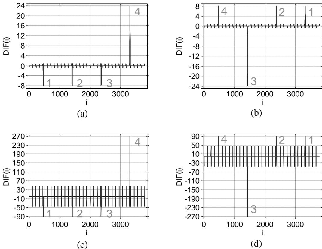
Slika 5.17: Graf vektora  $DIF(i)$ : (a)  $DIF(i)$  prema (5.17) za  $w = 11$ ,  $N = 15$ ,  $\sigma = 2.5$  i  $D(0) = 0^\circ$ , (b)  $DIF(i)$  prema (5.17) za  $w = 11$ ,  $N = 15$ ,  $\sigma = 2.5$  i  $D(0) = 180^\circ$ , (c)  $DIF(i)$  primijenjen na  $D(i)$  za  $D(0) = 0^\circ$  i (d)  $DIF(i)$  primijenjen na  $D(i)$  za  $D(0) = 180^\circ$ .
