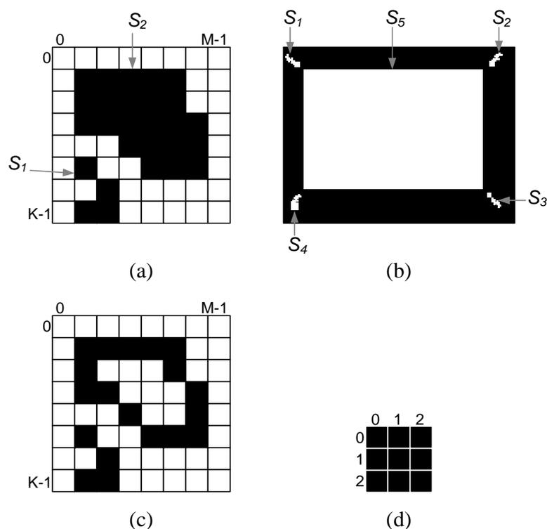
Slika 5.2: Primjer dvije  $S_1$  i  $S_2$  povezone komponente na sintetički generiranoj binarnoj slici (a), primjer pet povezanih komponenti ( $S_1 - S_5$ ) na binarnoj slici (PBSCD metoda) sirove keramičke pločice, (c) detektirani rub za primjer (a), (d)  $3 \times 3$  oblik povezone komponente. Na slici (a), (c) i (d) crni pravokutnik označava piksel s intenzitetom '1', a na slici (b) bijela boja predstavlja piksele s intenzitetom '1'.
