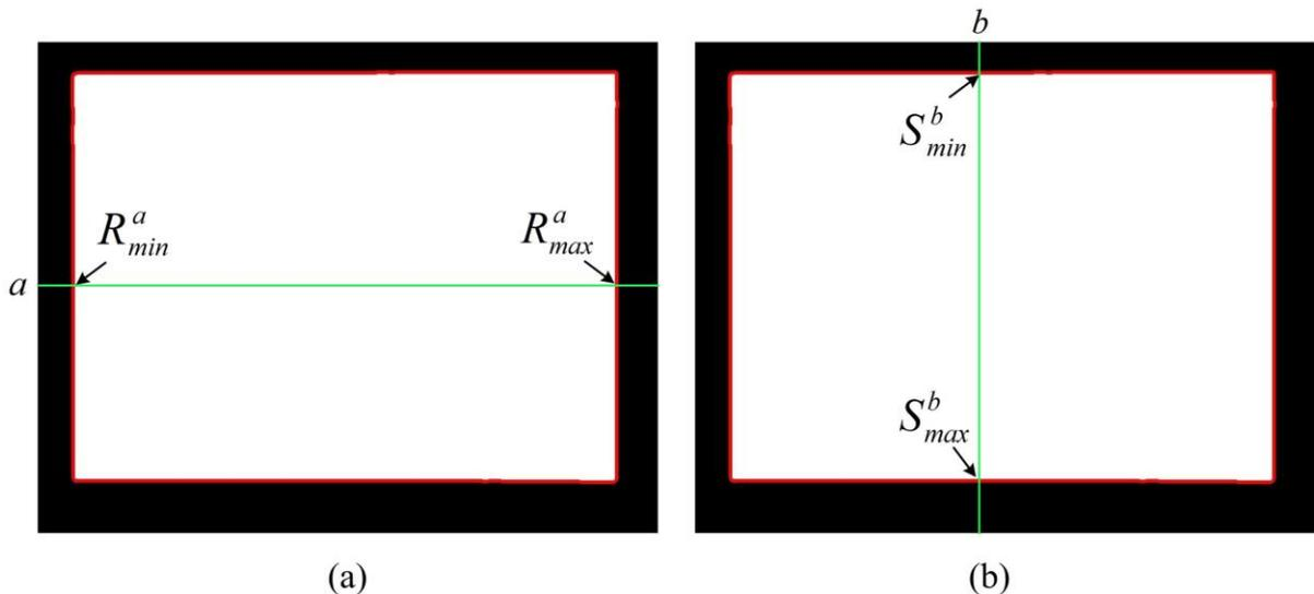
Slika 6.4: Primjer pronalaska  $R_{min}^a$  i  $R_{max}^a$  koordinata za redak  $a$  označen sa zelenom linijom (a), primjer pronalaska  $S_{min}^b$  i  $S_{max}^b$  koordinata za stubac  $b$  označen sa zelenom linijom, crvena linija označava točke vektora konture  $CE(i)$ .
