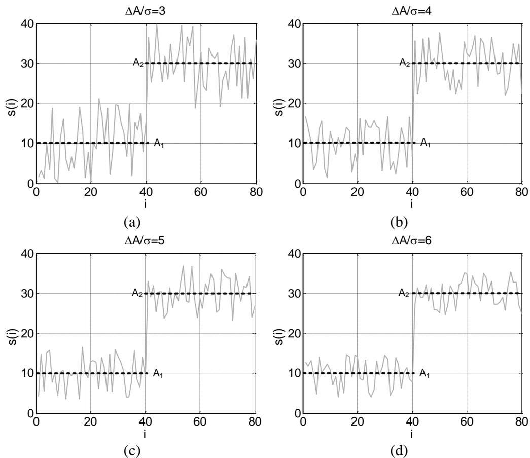
Slika 4.8: Primjeri četiri stohastička signala  $\mathbf{s}$  (siva linija) i njihovih aproksimacija  $\tilde{\mathbf{s}}$  (crtkana crna linija) s  $N = 80$ ,  $\Delta A = 20$ , (a)  $\Delta A/\sigma = 3$ , (b)  $\Delta A/\sigma = 4$ , (c)  $\Delta A/\sigma = 5$  i (d)  $\Delta A/\sigma = 6$ .
