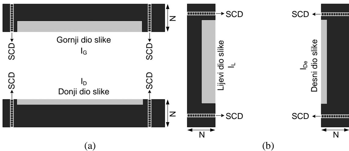
Slika 4.13:  $I_G$  i  $I_D$  slike s primjerom primjene SCD metode na stupce bez piksela sirove pločice (a),  $I_L$  i  $I_{De}$  slike s primjerom primjene SCD metode na redove bez piksela sirove pločice (b).
