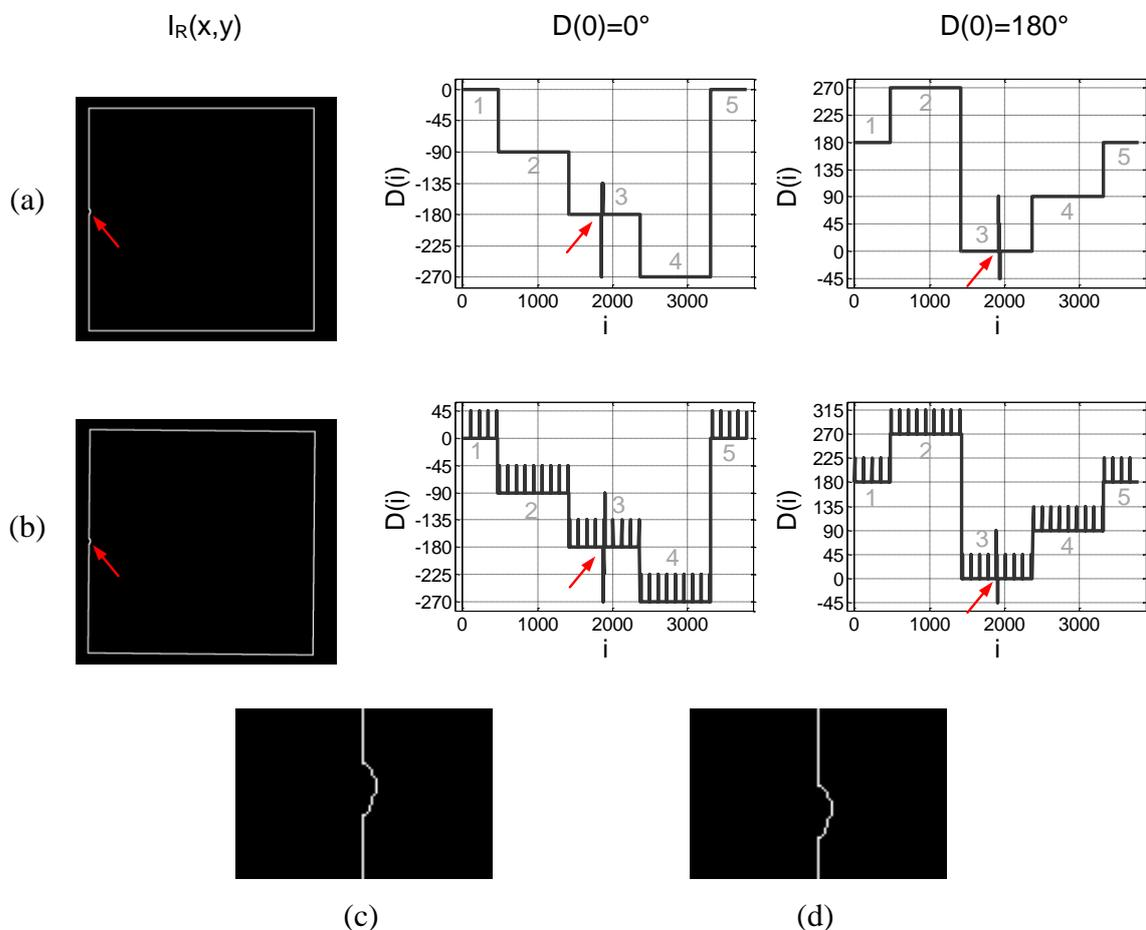
Slika 5.11: Smjer konture za sintetički generiranu binarnu sliku sirove pločice s kutom rotacije  $\gamma = 0^\circ$  i s jednom neispravnosti na lijevom rubu (a), s kutom rotacije  $\gamma = 0.5^\circ$  i s jednom neispravnosti na lijevom rubu (b), uvećani dio slike ruba (a) i (b) s vidljivom neispravnosti na rubu (c) i (d)
