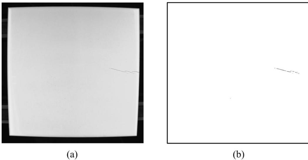
Slika 7.2: Primjer detektiranih linijskih neispravnosti MALD metodom.
