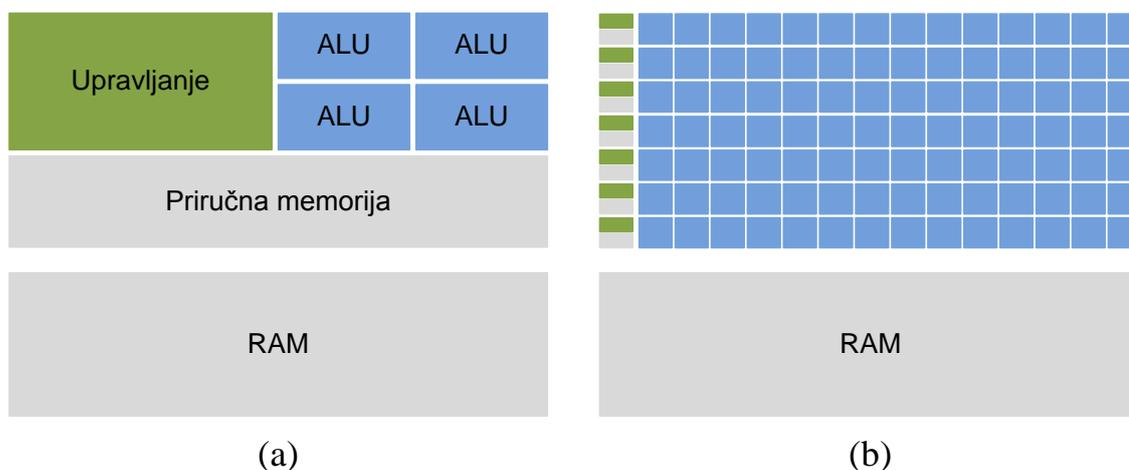
Slika 4.16: Shematski prikaz rasporeda tranzistora u CPU (a) i GPU (b).
