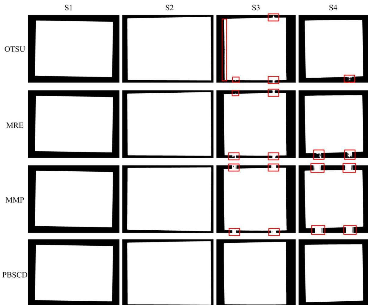
Slika 4.28: Rezultati binarizacije za primjere  $S1$  (prvi stupac),  $S2$  (drugi stupac),  $S3$  (treći stupac) i  $S4$  (četvrti stupac) sa: Otsu metodom (prvi red), metodom minimalne razlike entropije – MRE (drugi red), metodom minimalne pogreške – MMP (treći red) i PBSCD metodom (četvrti red). Crveni pravokutnici označavaju pogrešno binarizirane piksele.
