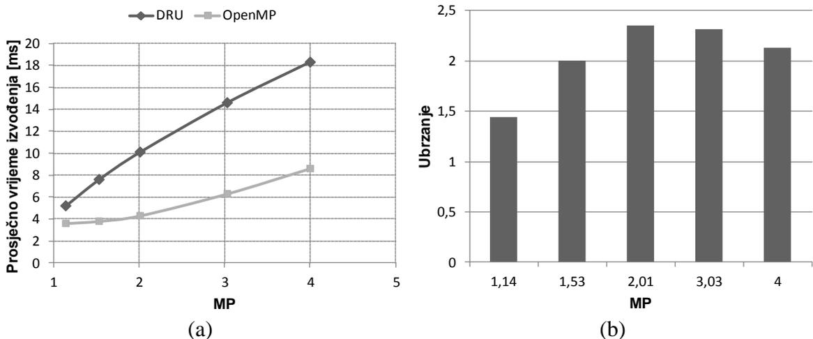
Slika 5.26: Prosječno vrijeme izvođenja u 100 iteracija paralelnog OpenMP algoritma i sekvencijalnog algoritma (DRU) predložene metode za detekciju neispravnosti na rubovima i uglovima sirovih pločica (a), (b) ubrzanje paralelnog algoritma u odnosu na sekvencijalni algoritam.
