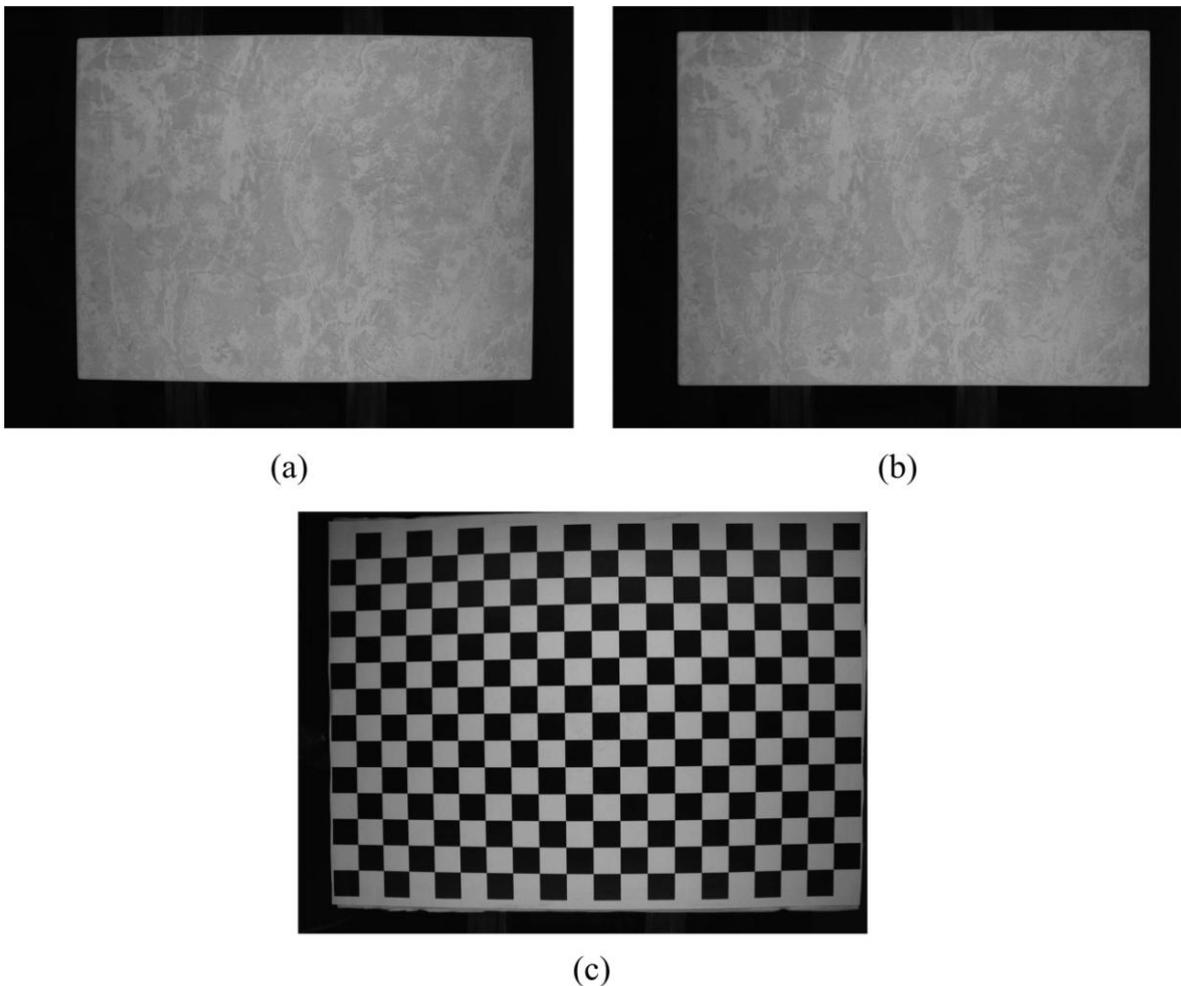
Slika 3.6: Primjer sive slike s geometrijskom bačvastom distorzijom (a), slika s uklonjenom bačvastom distorzijom, (c) slika s uzorkom šahovske ploče.
