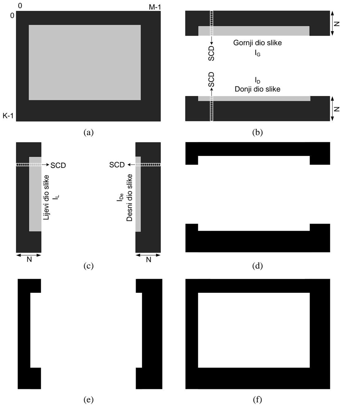
Slika 4.12: PBSCD metoda: (a) primjer ulazne  $I(x, y)$  sive slike veličine  $K \times M$  piksela, (b) gornji  $I_G$  i donji  $I_D$  dio slike prema (4.25), (c) lijevi  $I_L$  i desni  $I_{De}$  dio slike prema (4.25), (d) međurezultat binarizacije prema (4.26), (e) međurezultat binarizacije prema (4.27), (f) konačni rezultat binarizacije PBSCD metode (bijela boja predstavlja objekt, a crna pozadinu).
