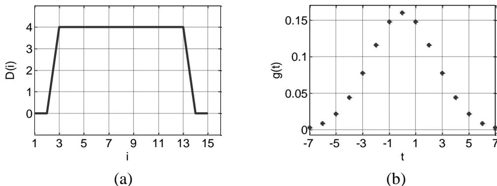
Slika 5.15: Primjer stepeničastog skoka nastalog zbog nesavršenosti linije piksela ruba nakon osrednjavanja za  $w = 11$  (a), (b) graf uzorkovane Gaussove funkcije za  $N = 15$ ,  $t = [-7, 7]$  s korakom 1 i  $\sigma = 2.5$ .
