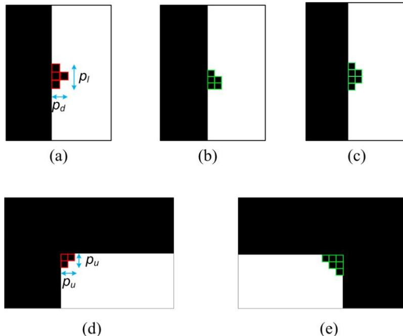
Slika 5.22: Generirane neispravnosti na rubovima sirove pločice sa:  $p_p = 4$ ,  $p_l = 3$  i  $p_d = 2$  (a), (b)  $p_p = 5$ ,  $p_l = 3$  i  $p_d = 2$  (c)  $p_p = 6$ ,  $p_l = 4$  i  $p_d = 2$ . Generirane neispravnosti na uglovima sirove pločice sa:  $p_u = 2$  (d) i (e)  $p_u = 3$ .
