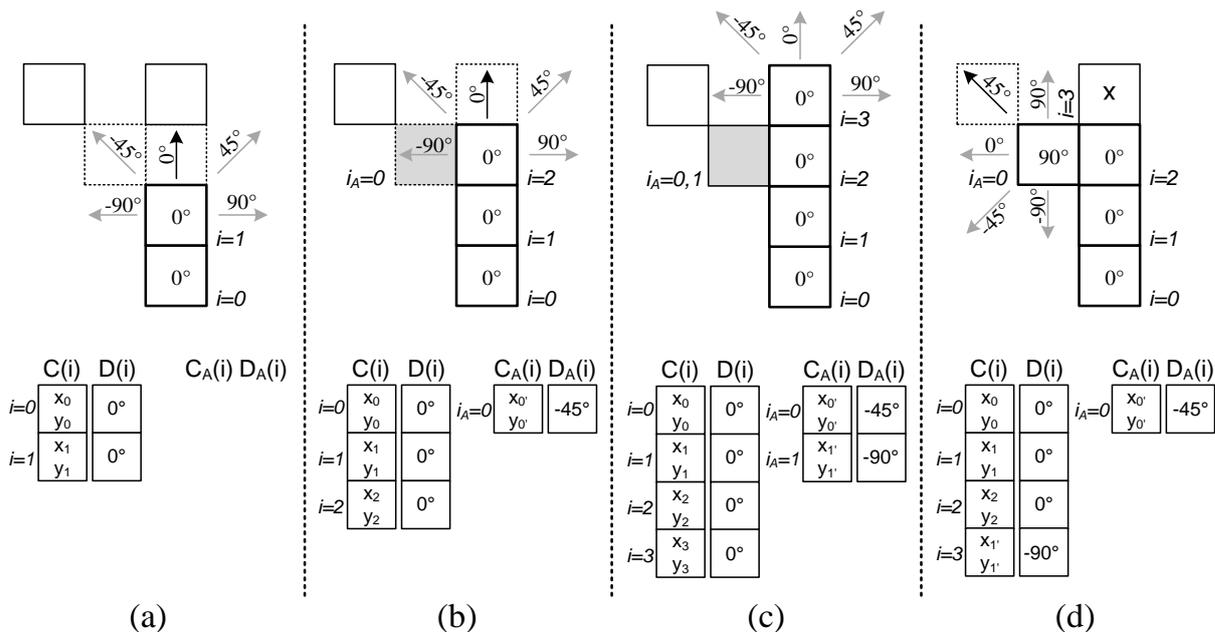
Slika 5.6: Primjer četiri koraka (a) do (d) praćenja konture i popunjavanje vektora konture  $C(i)$ , vektora smjera konture  $D(i)$ , vektora alternativnih točaka konture  $C_A(i)$  i vektora alternativnog smjera konture  $D_A(i)$ . Sivi kvadrat predstavlja alternativnu točku konture, 'x' predstavlja odbačenu točku konture (nastao prekid konture).
