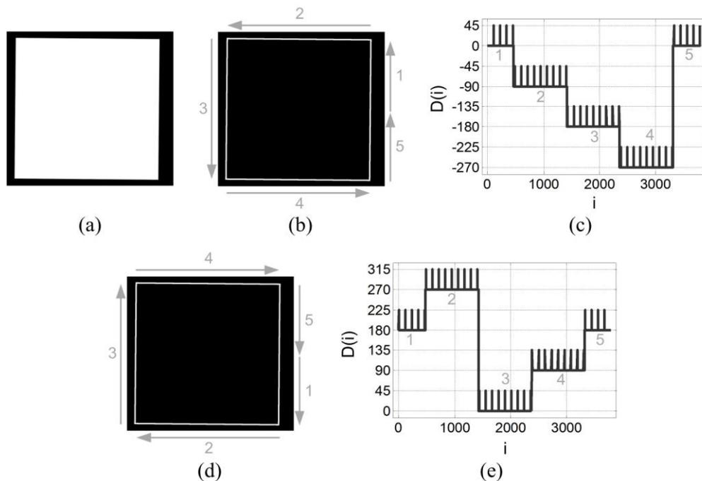
Slika 5.8: Primjer smjera konture: (a) sintetički generirana binarna slika sirove pločice  $I_B(x, y)$  s kutom rotacije  $\gamma = 0.5^\circ$ , (b) slika ruba  $I_R(x, y)$  s naznačenim smjerom praćenja konture za  $D(0) = 0^\circ$ , (c) graf smjera konture  $D(i)$  za  $D(0) = 0^\circ$ , (d) slika ruba  $I_R(x, y)$  s naznačenim smjerom praćenja konture za  $D(0) = 180^\circ$ , (e) graf smjera konture  $D(i)$  za  $D(0) = 180^\circ$ .
