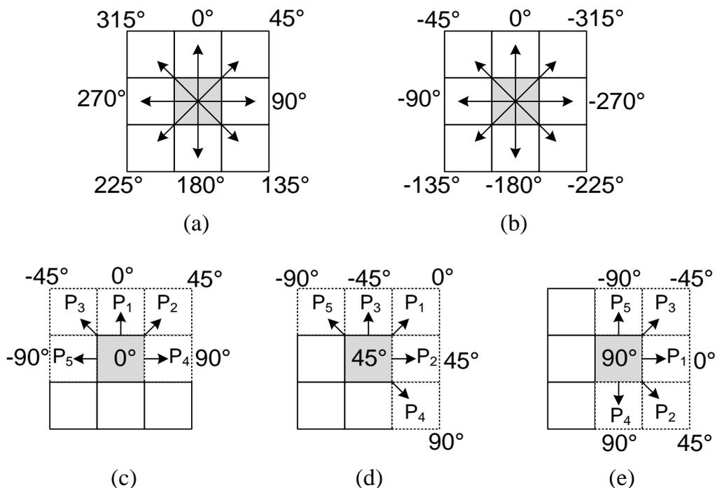
Slika 5.4: Mogući smjerovi konture za piksel sive boje (a) i (b). Primjeri  $N_5^{D(i)}$  susjedstva i prioriteta pretraživanja susjedstva za trenutni smjer konture  $D(i) = 0^\circ$  (c),  $D(i) = 45^\circ$  (d) i  $D(i) = 90^\circ$  (e).
