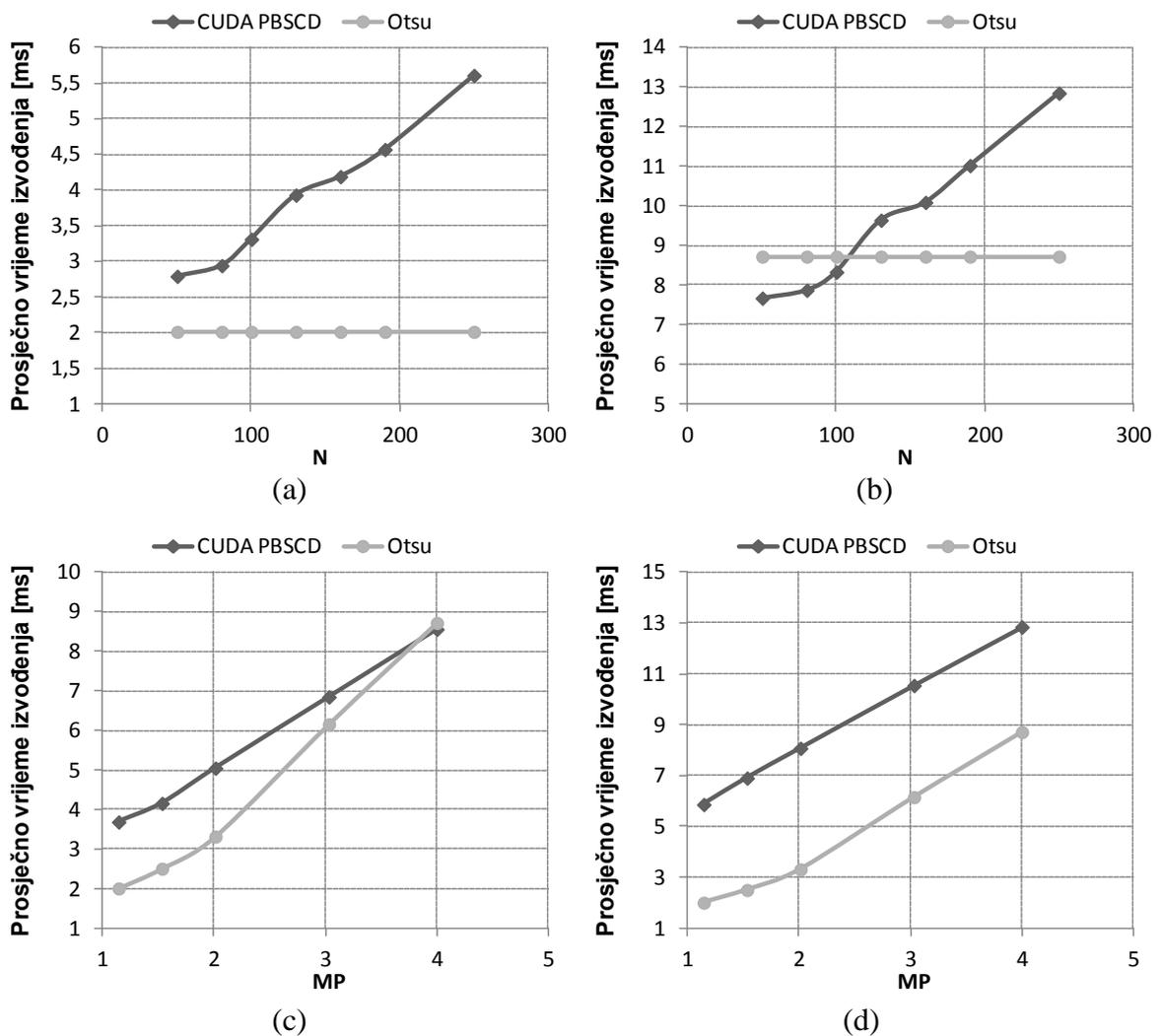
Slika 4.29: Prosječno vrijeme izvođenja u 100 iteracija CUDA PBSCD i Otsu metode: (a) slika veličine  $1038 \times 1098$  piksela i promjenjivi  $N$ , (b) slika veličine  $1946 \times 2054$  piksela i promjenjivi  $N$ , (c)  $N = 120$  i promjenjiva veličina slike izražena u megapikselima ( $MP$ ), (d)  $N = 250$  i promjenjiva veličina slike u  $MP$ .
