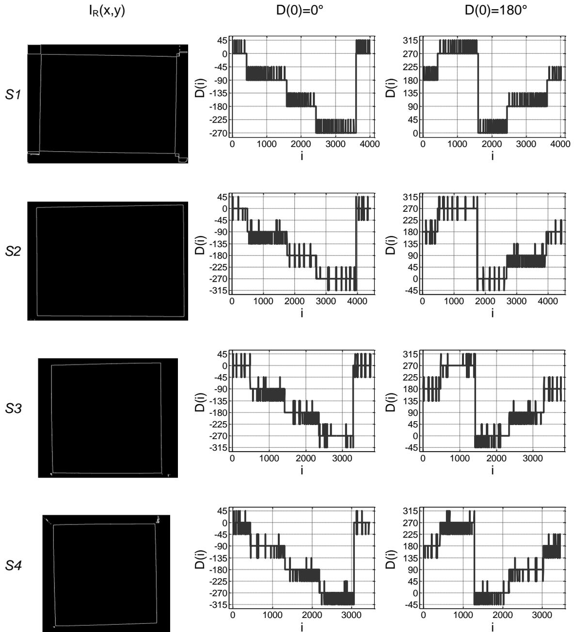
Slika 5.10: Smjer konture za primjere slika sirovih pločica  $S1$ ,  $S2$ ,  $S3$ , i  $S4$  (označeni redovi) iz poglavlja 4.9. Stupac  $I_R(x, y)$  predstavlja slike ruba za pojedini primjer slika, stupac  $D(0) = 0^\circ$  predstavlja grafove smjera konture sa početnim smjerom konture  $0^\circ$ , stupac  $D(0) = 180^\circ$  predstavlja grafove smjera konture sa početnim smjerom konture  $180^\circ$ .
