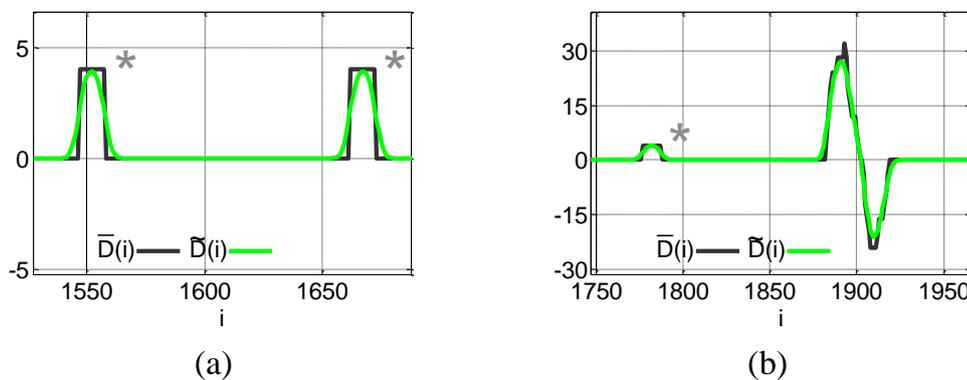
Slika 5.16: Uvećani dio grafa vektora smjera konture nakon osrednjavanja (crna linija) i ublažavanja s digitalnim Gausovom filterom (zelena linija) za  $w = 11$ ,  $N = 15$ ,  $\sigma = 2.5$ : (a) stepeničasti skokovi nastali zbog nesavršenosti linije piksela ruba označeni s \*, (b) stepeničasti skokovi nastali zbog neispravnosti na rubu.
