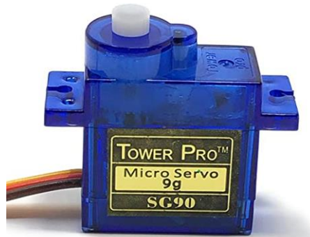
Slika 3.7. TowerPro SG90 servo motor.
