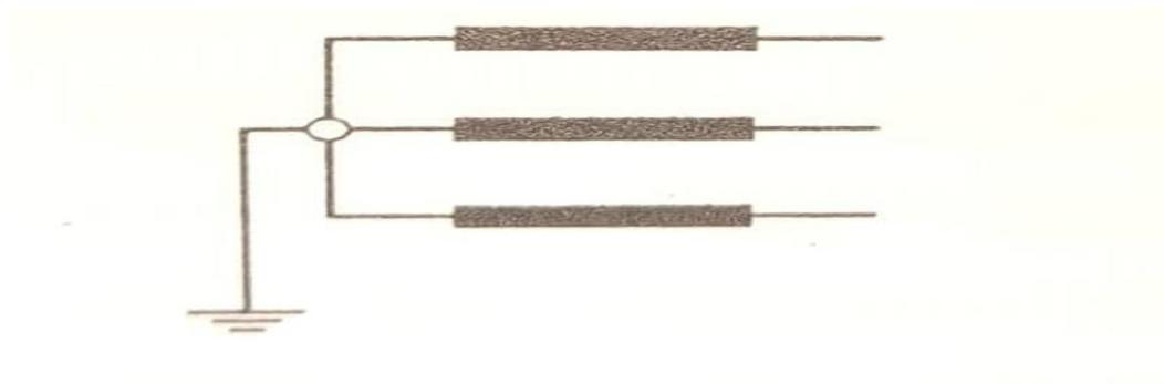
**Slika 3.1** Pogonsko uzemljenje.
