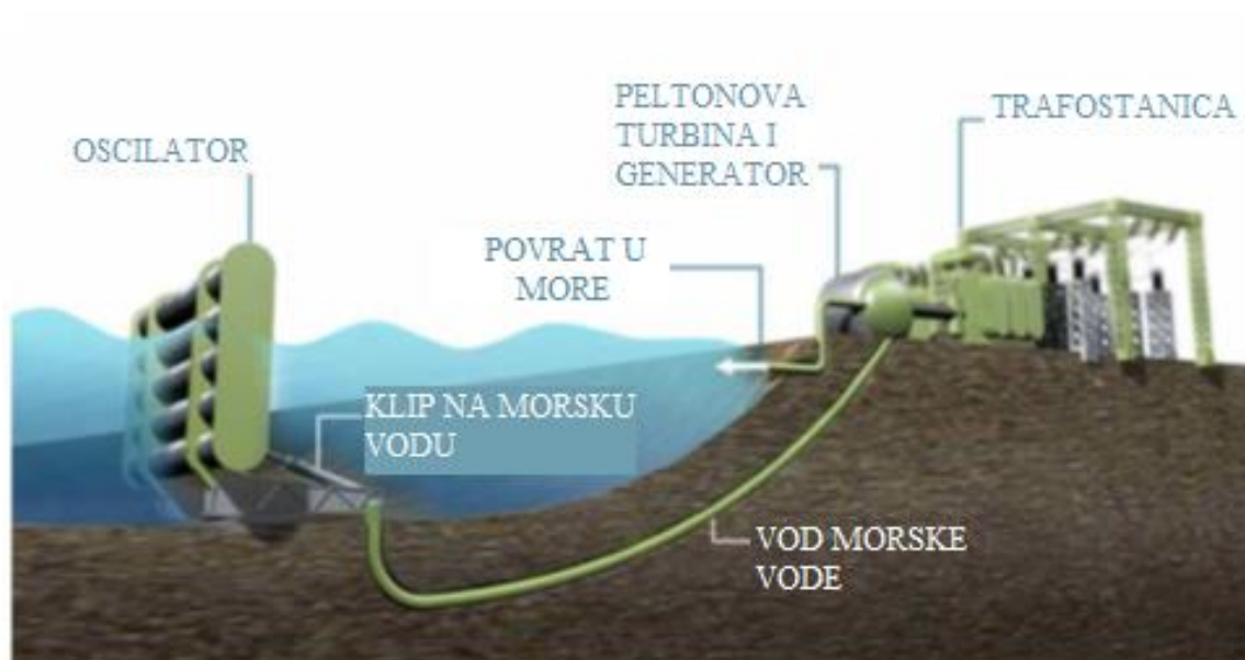
Slika 3.7. Primjer OSWEC-a : Power Oyster 800 [1]
