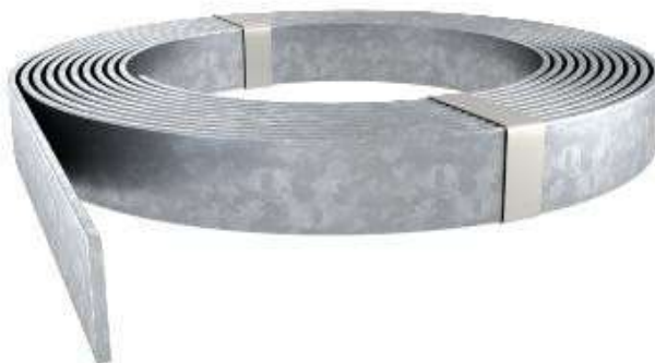
Slika 4.6. Traka uzemljivača FeZn 25x4 mm [14]
