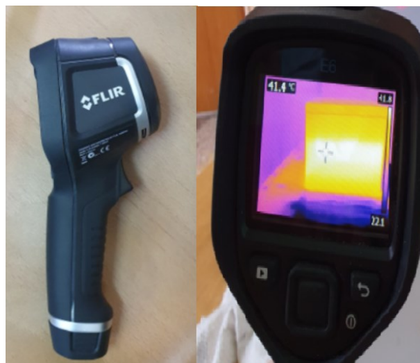
Slika 4.2 Termografska kamera FLIR E6
