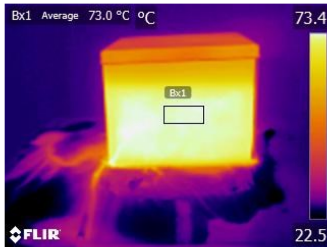
Slika 4.32. Termogram metalne kutije pri kutu 0° (-90°)
