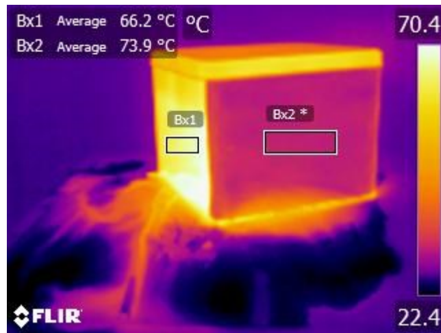
Slika 4.38. Termogram metalne kutije pri kutu 60° (-30°)
