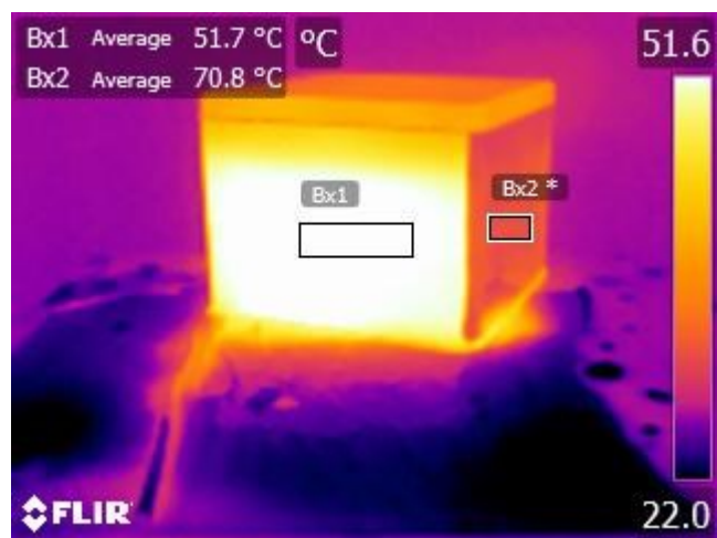
Slika 4.56. Termogram metalne kutije pri kutu 20° (-70°)
