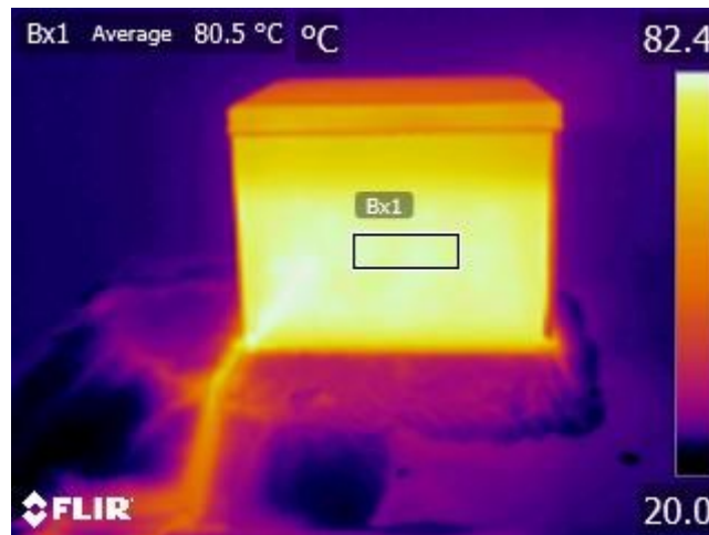
Slika 4.21. Termogram metalne kutije pri kutu 0° (-90°)
