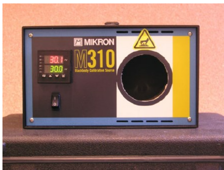
Slika 2.4 Praktična realizacija crnog tijela [1]
