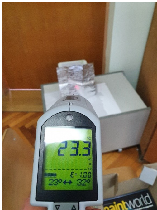
Slika 4.6. Mjerenje reflektiranog zračenja uz pomoć pirometra
