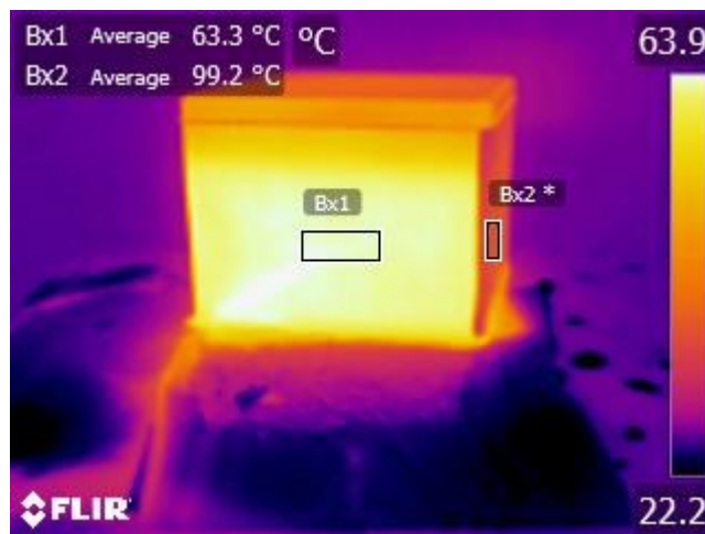
Slika 4.44. Termogram metalne kutije pri kutu 10° (-80°)
