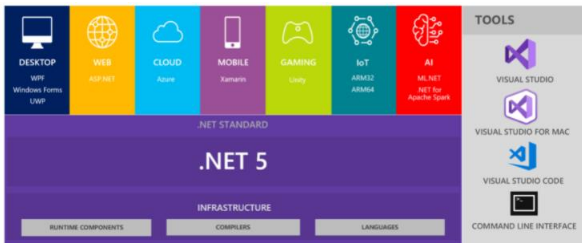
Slika 3.2. Prikaz strukture .NET 5 platforme 3
