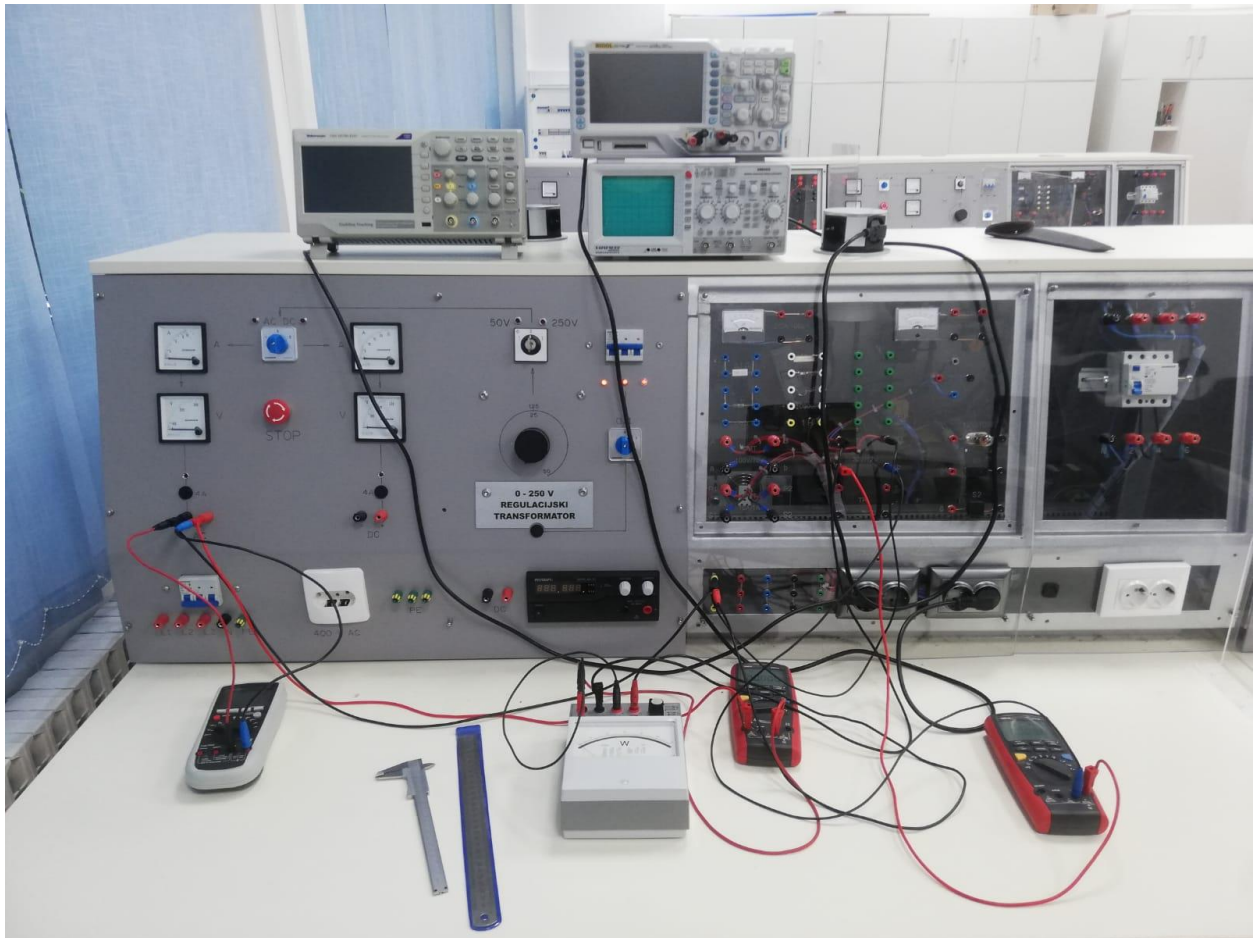
Slika 7.2. Pokus praznog hoda
