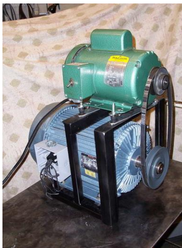
Slika 6.5. Primjer sinkronoga motora koji se zalijeće pomoćnim motorom [36].
