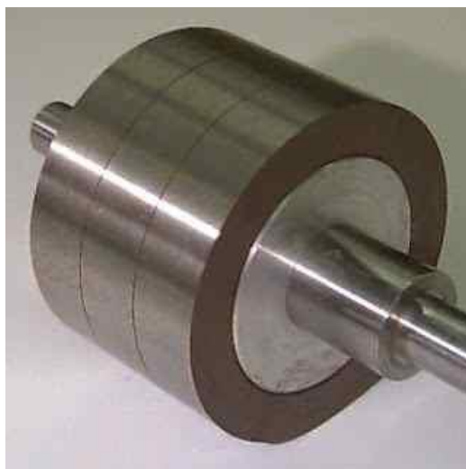
Slika 6.7. Rotor histereznog sinkronog motora [38].
