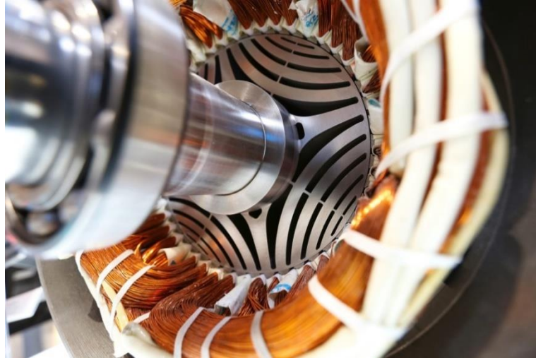
Slika 6.11. Unutarnji izgled sinkronog reluktantnog motora [41].
