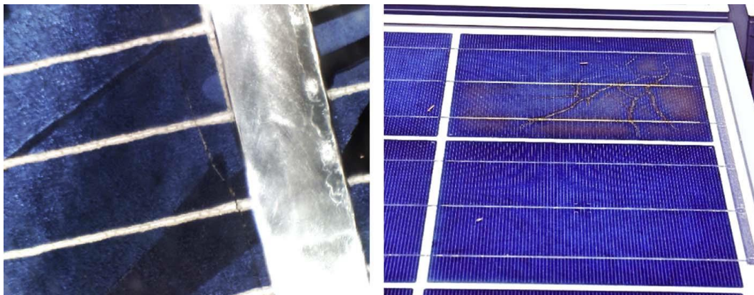
Sl. 3.14. Pukotina na članku (lijevo) i puževi tragovi (desno) [28].
