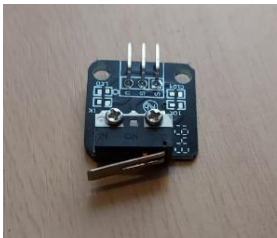
Slika 7. tipka , endstop za 3D pisač
