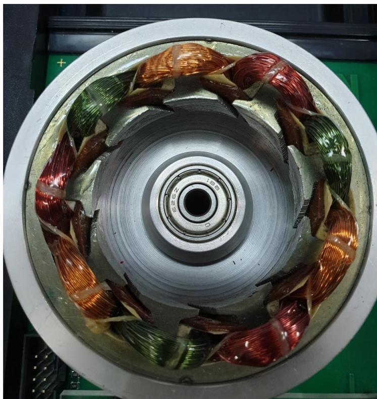
Slika 4.2. Namoti unutar statora
