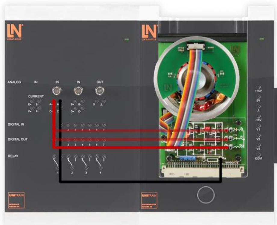
Slika 6.3. Shema spajanja za određivanja naponskih razina
