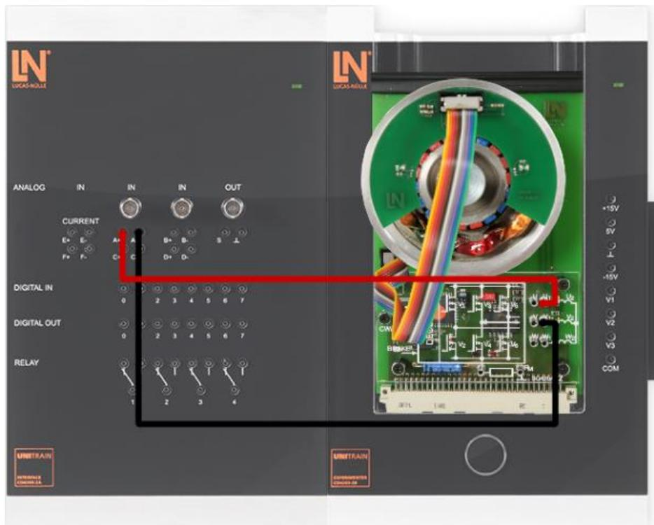
Slika 6.9. Shema spajanja za mjerenje inducirano napona
