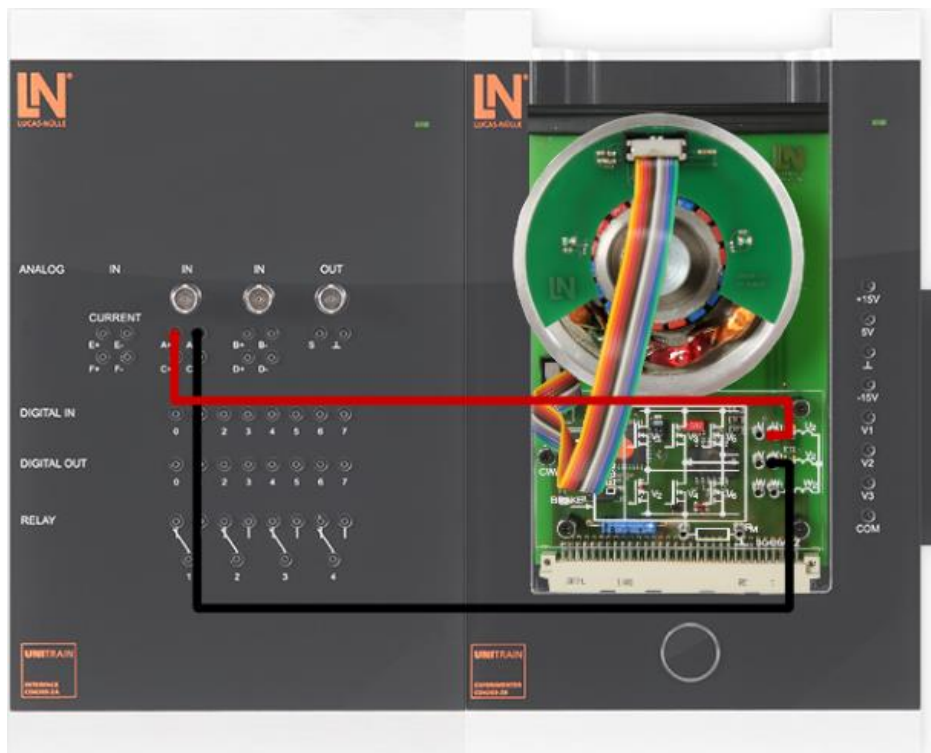
Slika 6.9. Shema spajanja za mjerenje inducirano napona
