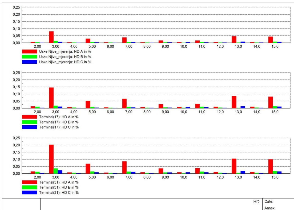
Slika 4.10. Prvih 15 harmonika u sve tri faze uz kompenzaciju i aktivan filter na sredini izvoda
