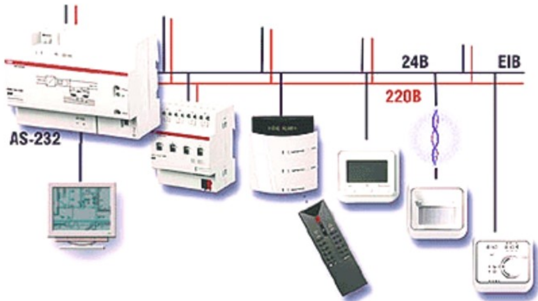
SI.4.2 Elementi naprednog sustava upravljanja rasvjetom, [10]
