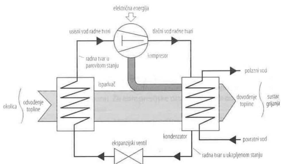
Slika 2.1 Pojednostavljeni prikaz rada kompresijske dizalice topline [1]
