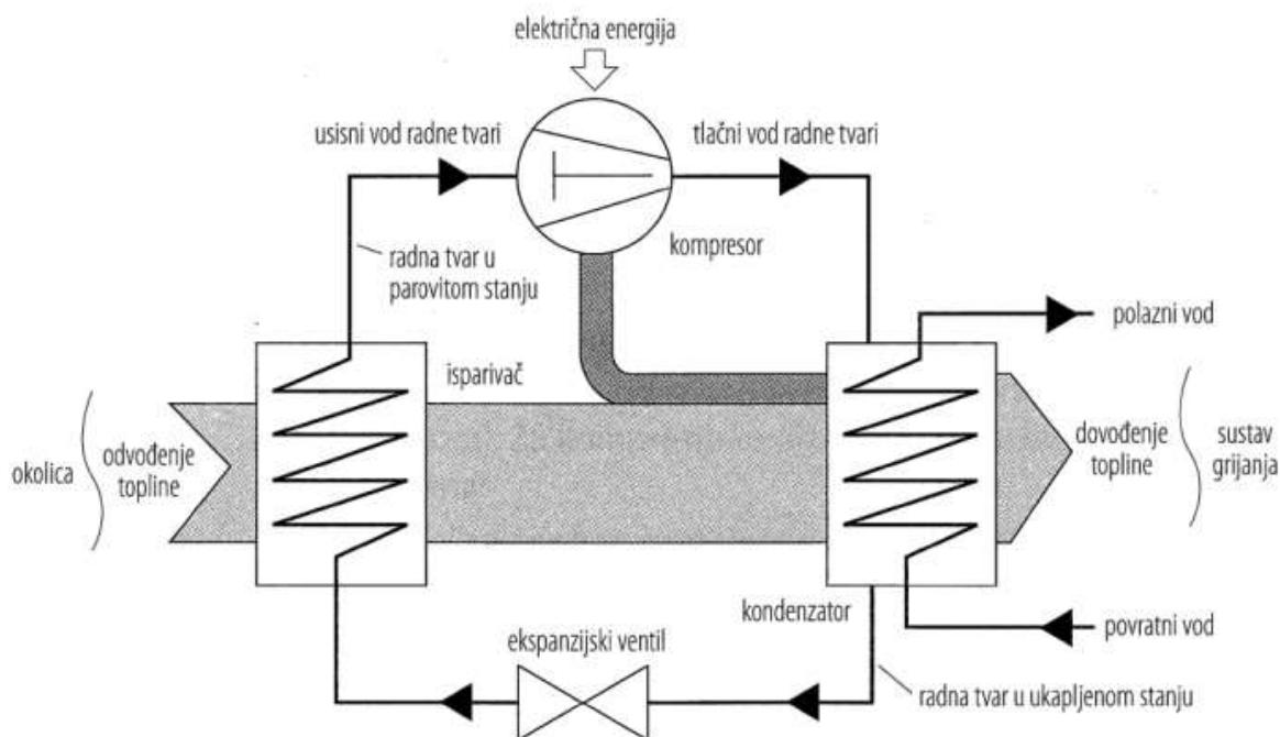
Slika 2.2 Pojednostavljeni prikaz rada (kompresijske) dizalice topline [1]
