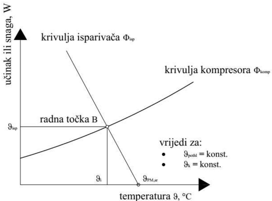
*Slika 2.3 Prikaz krivulja isparivača i kompresora te radne točke Q-v dijagrameom [1]*
