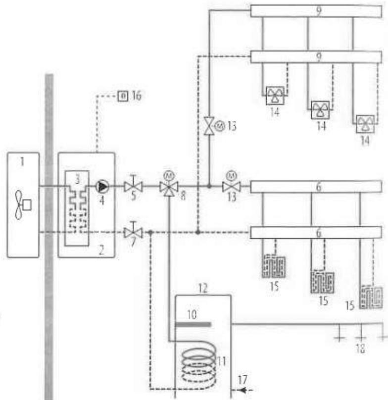
*Slika 4.2 Pojednostavljeni prikaz sustava grijanja, hlađenja i pripreme PTV-a s dizalicom topline zrak – voda kao izvorom toplinskog i rashladnog učinka [1]*
