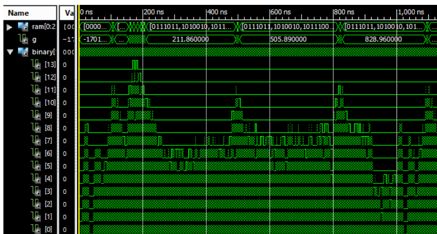
Sl. 5.16. Obrada signala za 14-bitni impulsni odziv u intervalu od 0ns do 1140ns u Xilinx ISE-u sprema se u RAM ako je vrijednost pretvorena u cijeli broj veća od 1500 [12]
