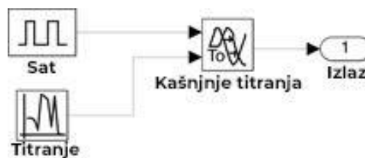
Sl. 5.7. Simulink blok shema uzorka sata s titranjem [12]
