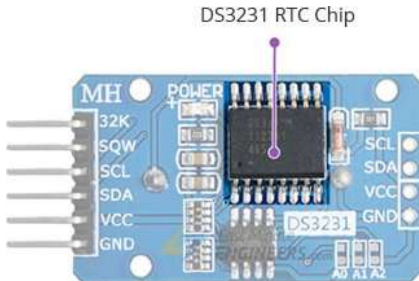
Slika 3.6. DS3231 modul sa označenim DS3231 RTC čipom [10]
