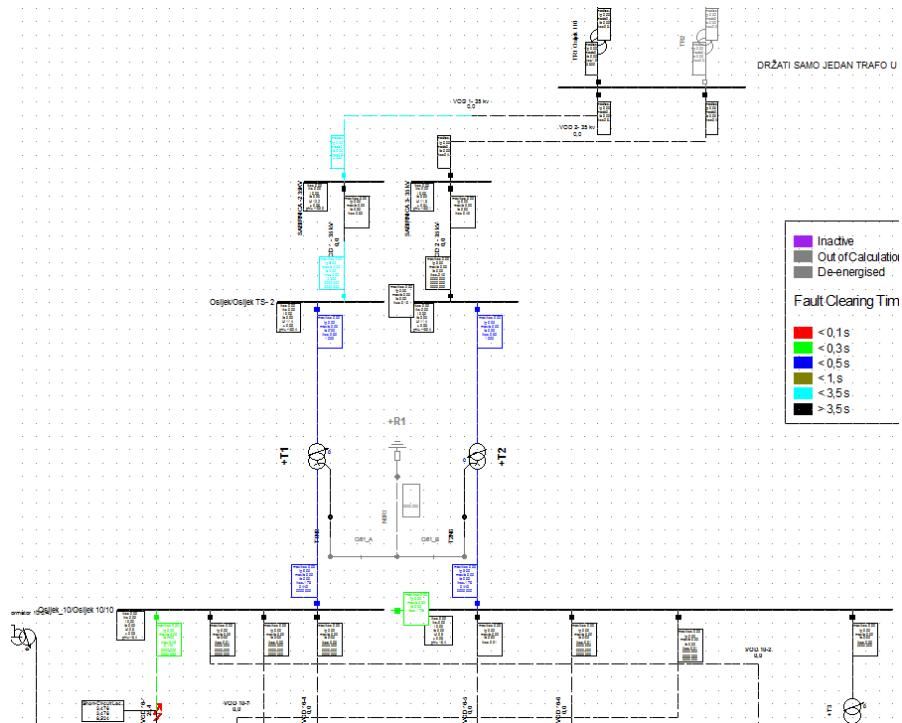
Slika 6.21. Princip stupnjevanja zaštite
