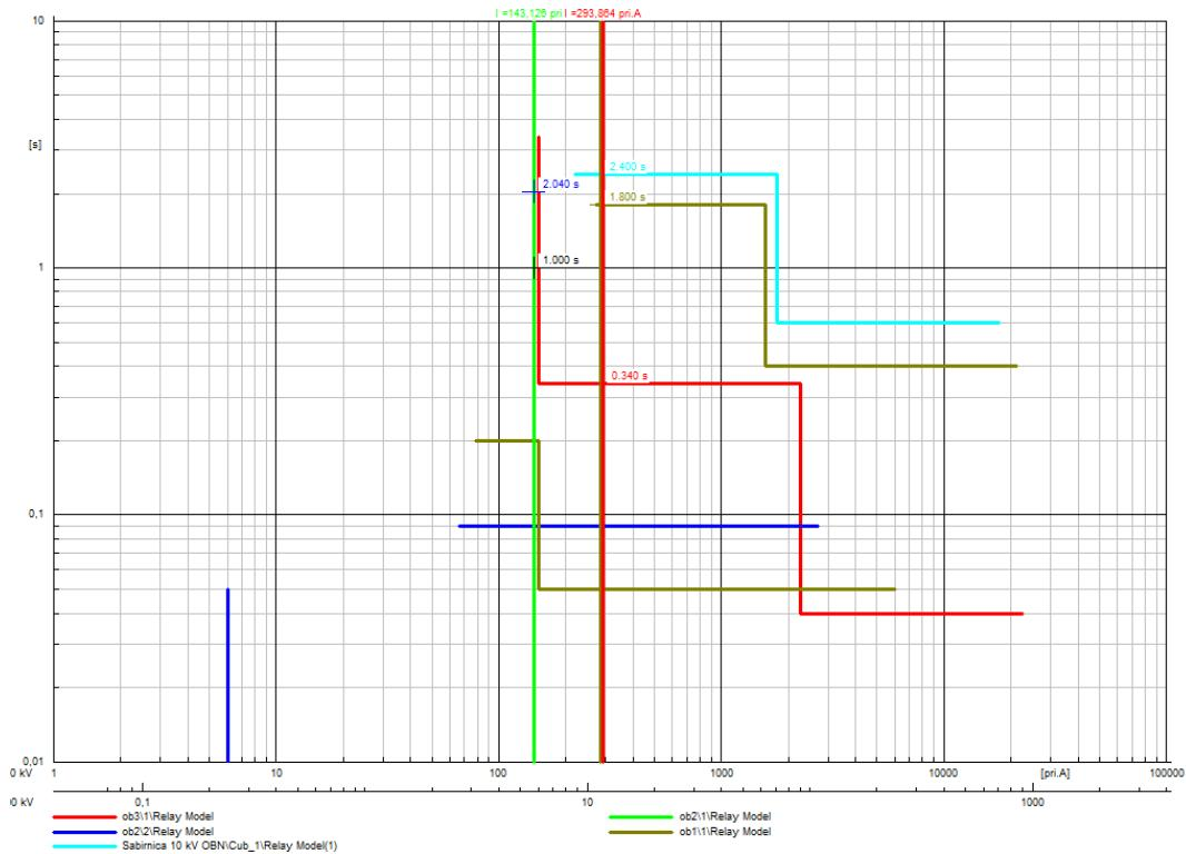
Slika 6.20. Stupnjevanje zaštite za sabirnicu OBN BUS 3 – 0.4 Kv
