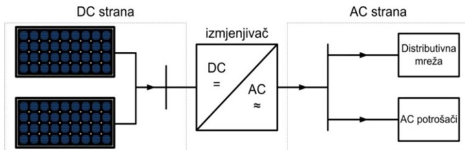
Slika 2.1. Prikaz načina priključenja fotonaponske elektrane na distribucijsku mrežu [6]
