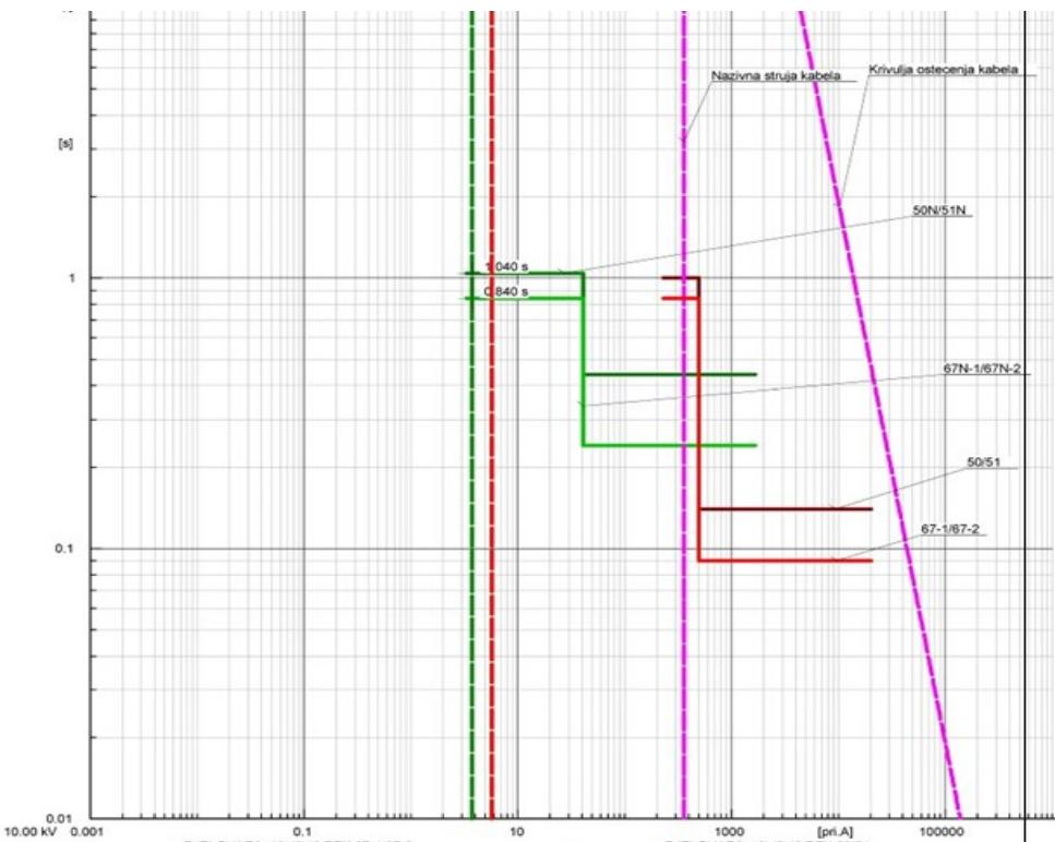
Slika 6.10. Jednopoljni kratki spoj, transformator izoliran.
