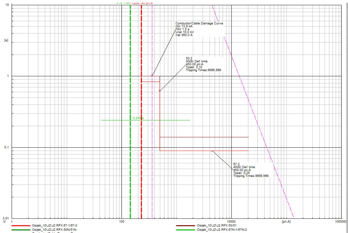
Slika 6.9. Jednopoljni kratki spoj, transformator uzemljen
