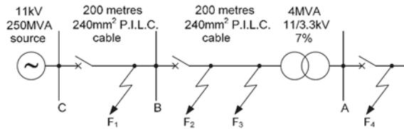
Slika 2.2. Radijalni sustav s vremenskim stupnjevanjem [1]
