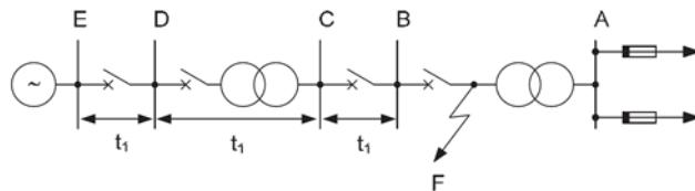
Slika 2.2. Radijalni sustav s vremenskim stupnjevanjem [1]
