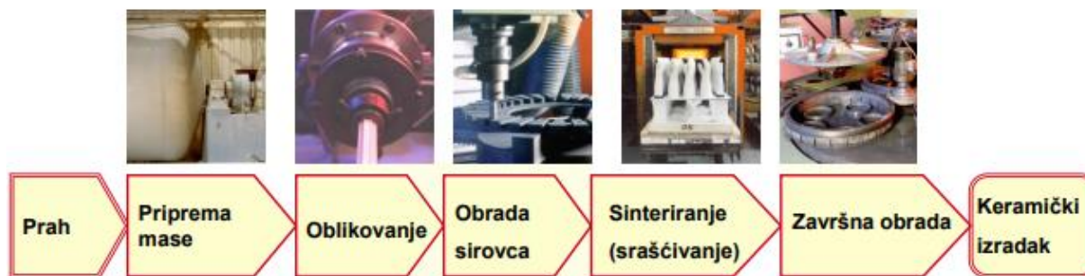
Sl. 3.6. Proces proizvodnje keramike [20].
