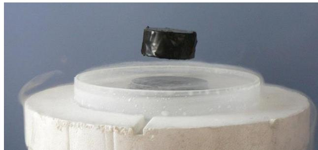
**Sl. 4.4.** Visokotemperaturni supravodič [25].
