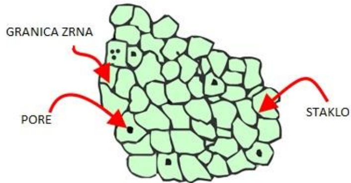
Sl. 3.2. Mikrostruktura keramike
