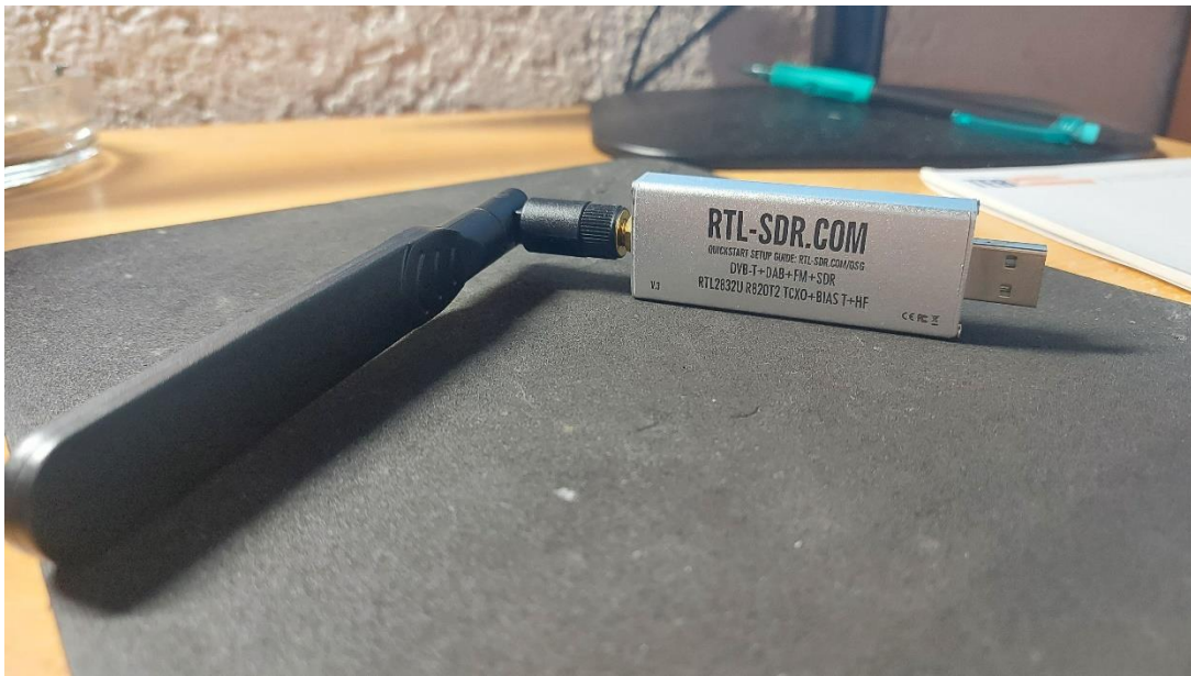
Slika 4.1. RTL-SDR uređaj s pripadajućom antenom
