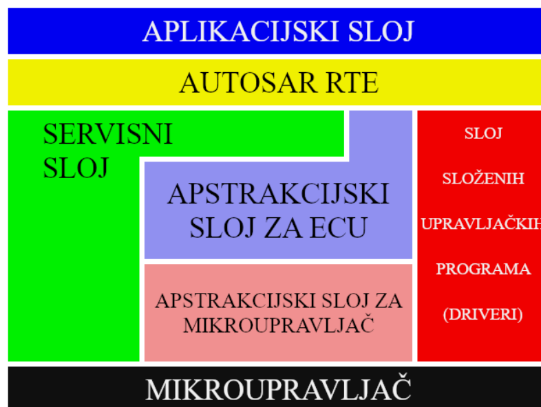
Slika 2.1: Pojednostavljena AUTOSAR slojevita arhitektura. Svi blokovi između blokova „Mikro upravljač“ i „AUTOSAR (RTE)“ odnose se na BSW.
