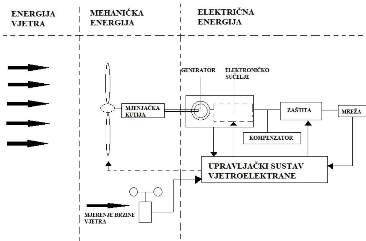
Slika 2.2. Shema vjetroelektrane s procesom pretvorbe energije
