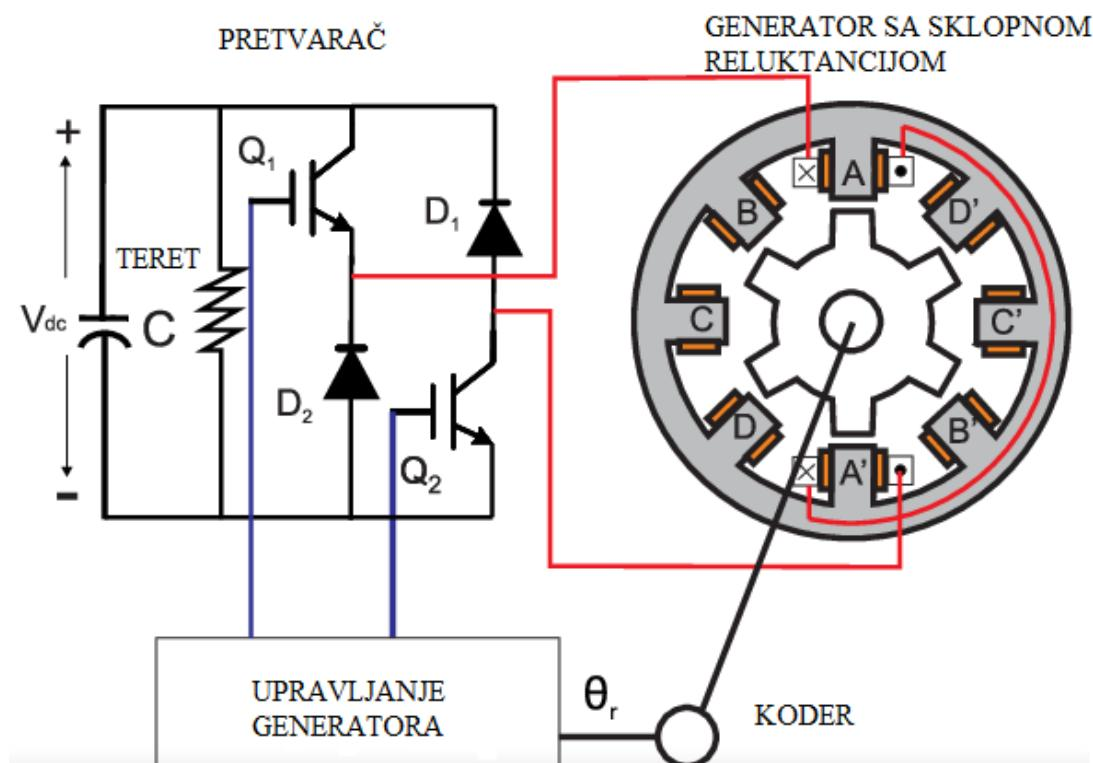
Slika 3.26. Presjek i izvedba generatora sa sklopnom reluktancijom [20]
