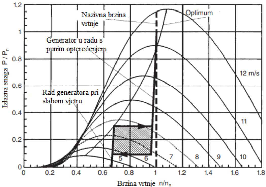
Slika 2.5. Karakteristika s vrijednostima brzine vrtnje i snage [8]
