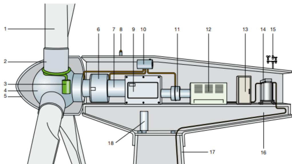
Slika 2.3. Presjek vjetroturbine sa detaljnim prikazom komponenti [6]
