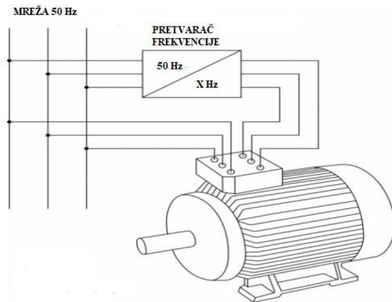
Slika 3.15. Konfiguracija dvostruko napajanog asinkronog generatora bez četkica [12]
