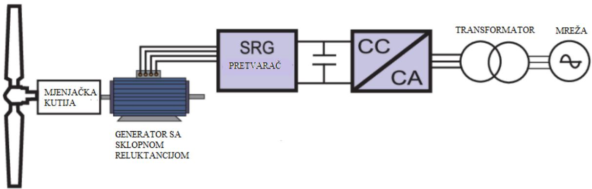
Slika 3.27. Struktura vjetroturbine sa generatorom sa sklopnom reluktancijom [20]
