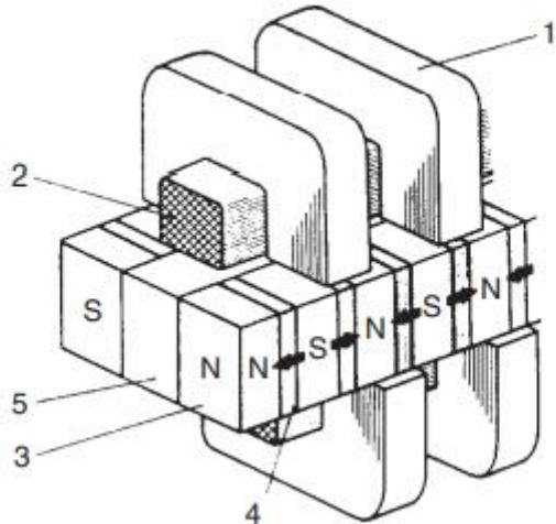
Slika 3.24. Dijelovi dizajna dvostranog poprečnog toka [8]
