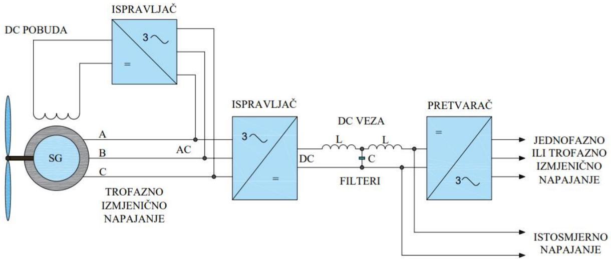
Slika 3.18. Shema rada sinkronog generatora
