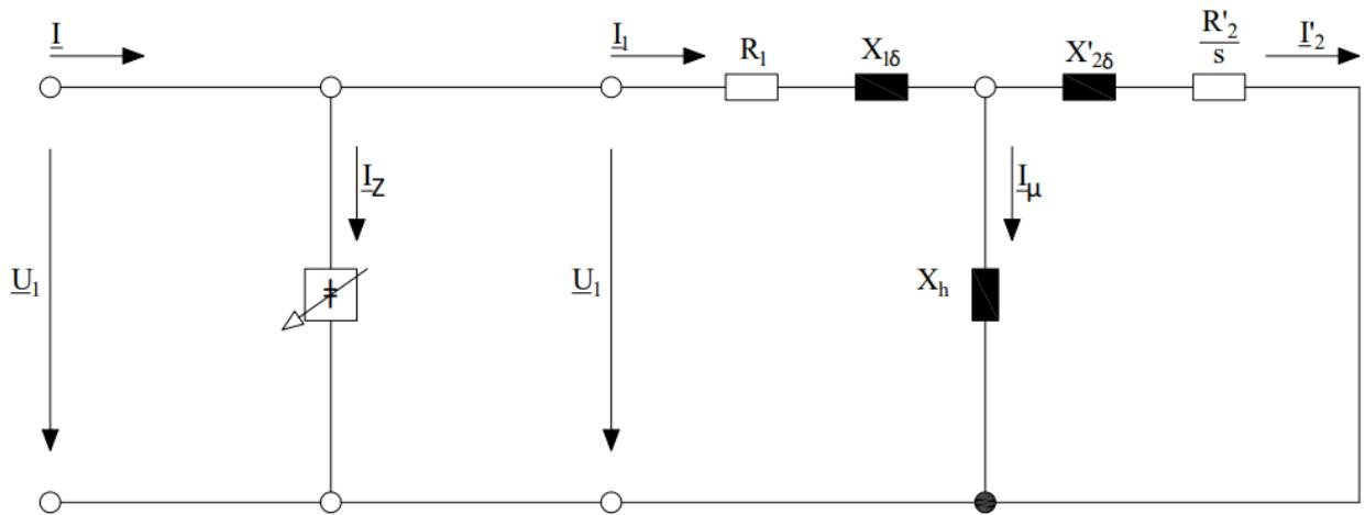
Slika 3.9. Strujni krug asinkronog stroja sa podešivom isporukom jalove energije
