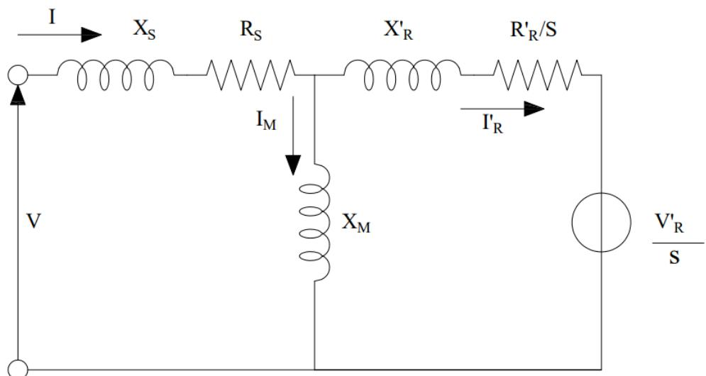
Slika 3.13. Strujni krug dvostruko napajanog asinkronog generatora
