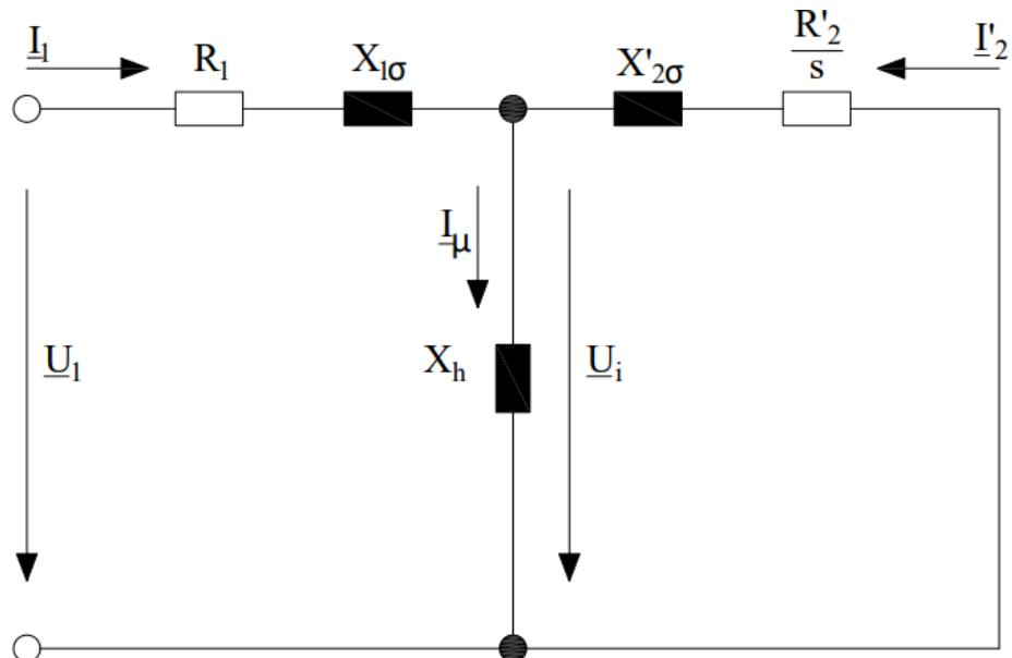
Slika 3.5. Prikaz strujnog kruga asinkronog generatora
