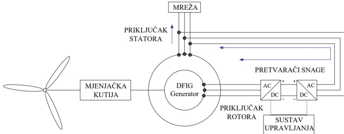
Slika 3.14. Shema dvostruko napajanog asinkronog generatora
