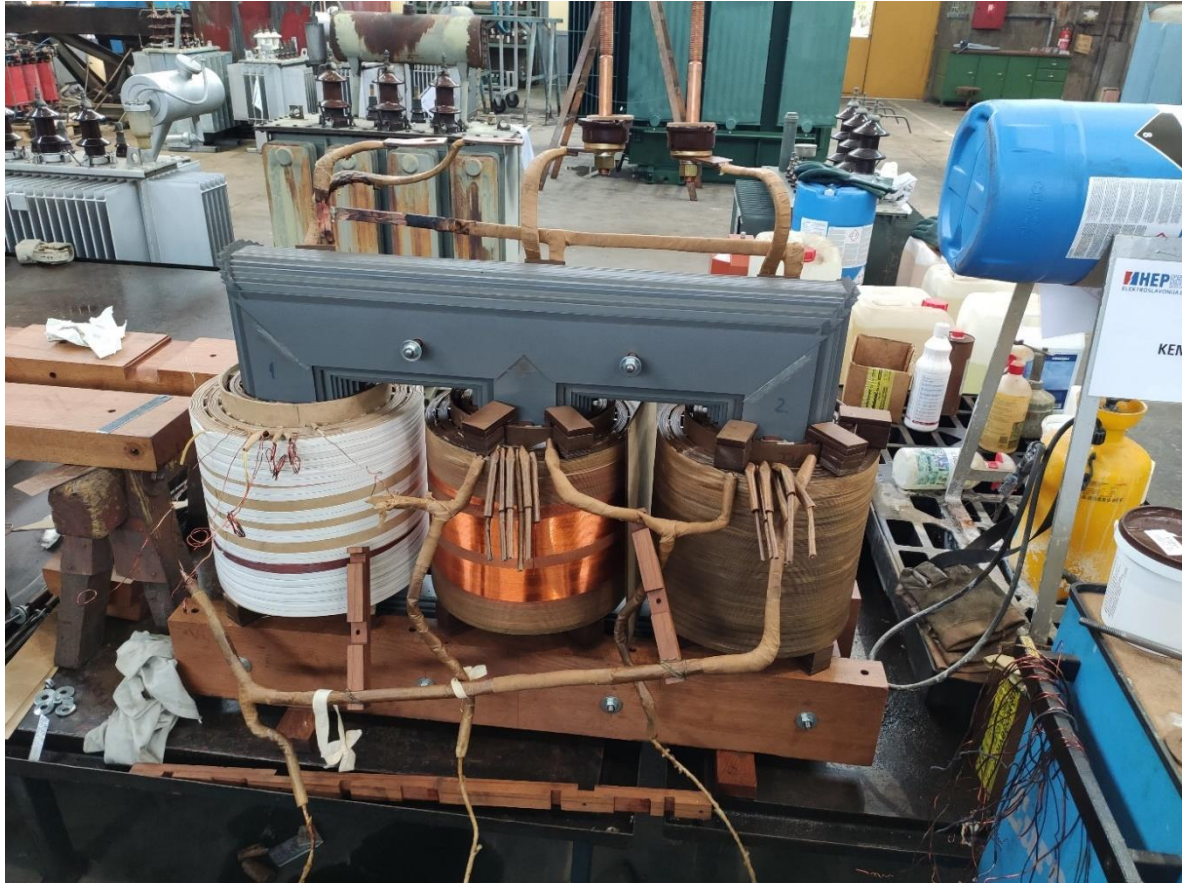
Slika 3.9. Prikaz namotanih namota oko stupova jezgre
