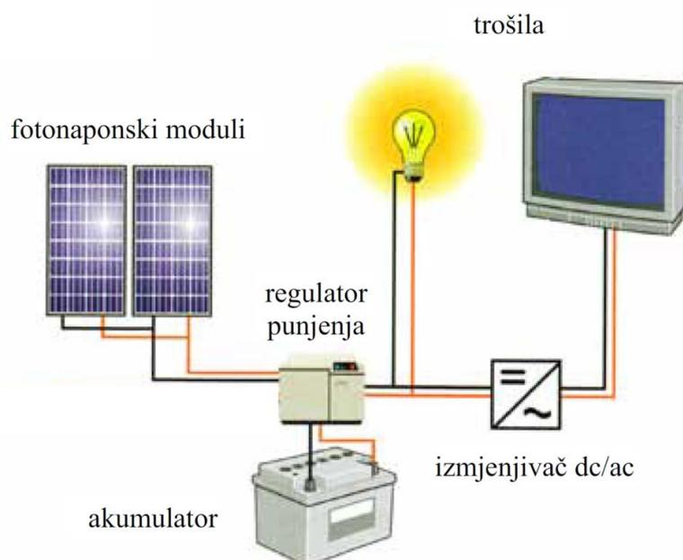
**Slika 4.5.** Spajanje fotonaponskih modula i izmjenjivača. [20]
