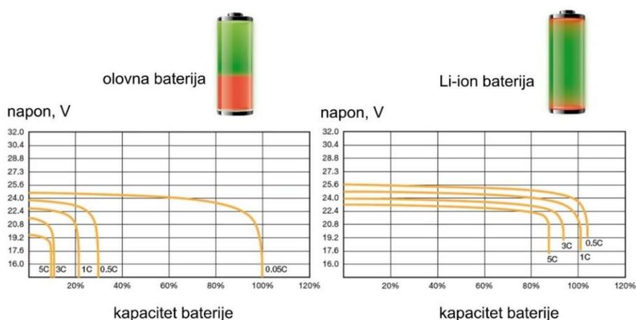
Slika 5. Zavisnost kapaciteta i napona o struji pražnjenja olovne i Li-ion baterije. [19]
