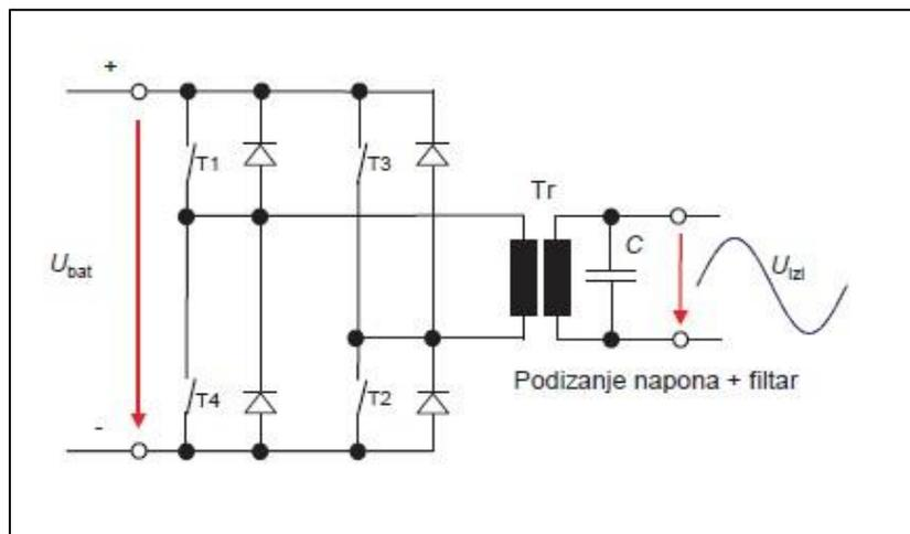
Slika 4.8. Autonomni izmjenjivač. [21]
