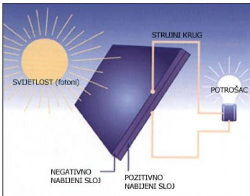
**Slika 4.2.** *Princip stvaranja napona u fotonaponskoj ćeliji. [14]*
