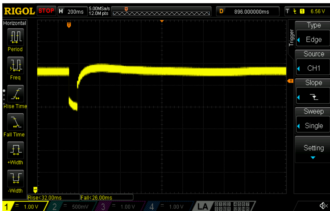
Slika 4.28a Kvar (kratki spoj) na vodu ln22 (snimka s osciloskopa)
