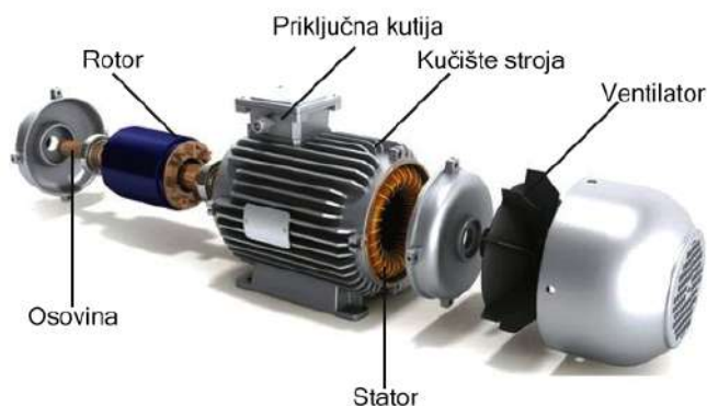
SL. 2.1: Konstrukcija asinkronog stroja [11]
