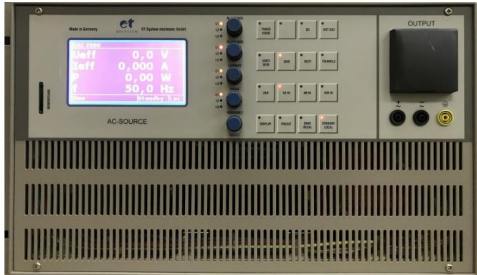
Slika 3.4. Izmjenični izvor ET System EAC-S2000.
