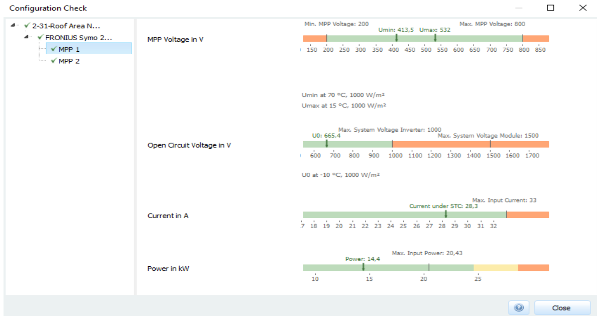
Sl. 3.11. Prikaz parametara FN nizova spojenih pod MPP1 ulaz u izmjenjivač
