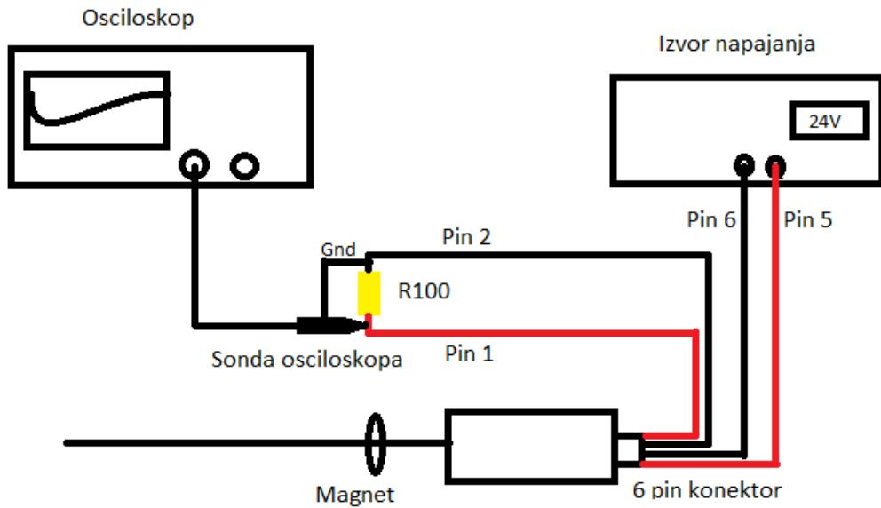
**Slika 4.3.** Shema mjernog spoja za snimanje dinamičke karakteristike.
