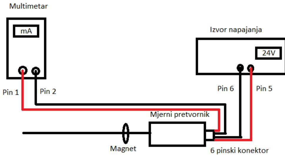
**Slika 4.1.** Shema mjernog spoja za snimanje statičke karakteristike.
