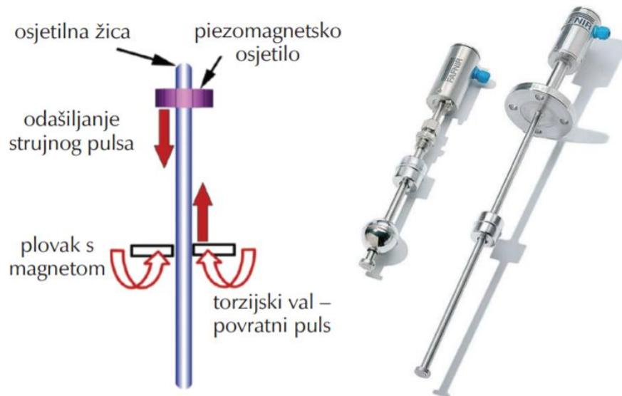
**Slika 2.5.** Načelo djelovanja magnetostriktivnih pretvornika razine.
