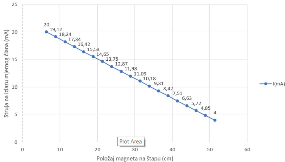
Slika 4.5. Grafički prikaz konstrukcije statičke karakteristike na temelju mjerjenih vrijednosti.
