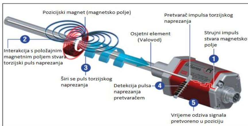
Slika 3.1. Vremenski baziran magnetostriktivni princip osjetljivosti položaja.
