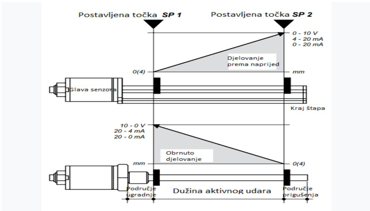
**Slika 3.8.** Raspon mjerjenja mjernog pretvornika.
