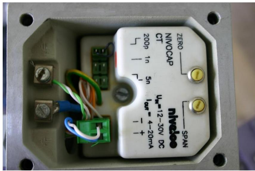
Slika P. 1.2. Unutrašnjost kućišta neispravnog mjernog člana.
