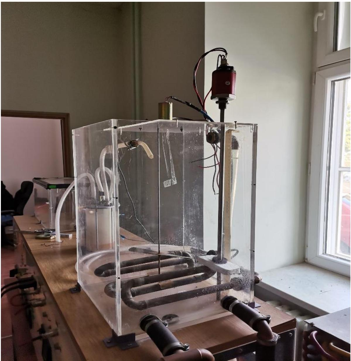
**Slika P. 1.4.** Spremnik za uskladištenje tekućine sa novim mjernim članom.
