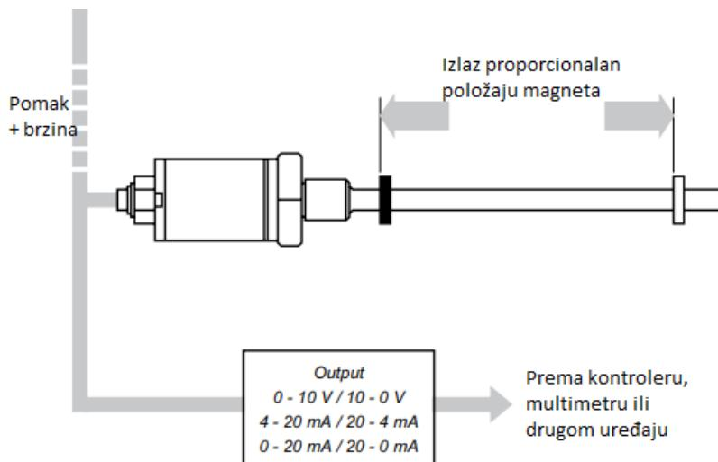
Slika 3.2. Analogni mjerni sustav.
