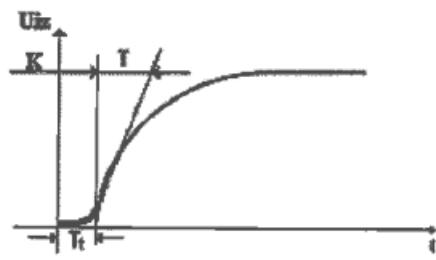
**Slika 2.3.** Odziv člana s PT<sub>1</sub>T<sub>t</sub> – vladanjem na step pobudu i određivanje vremenske konstante.
