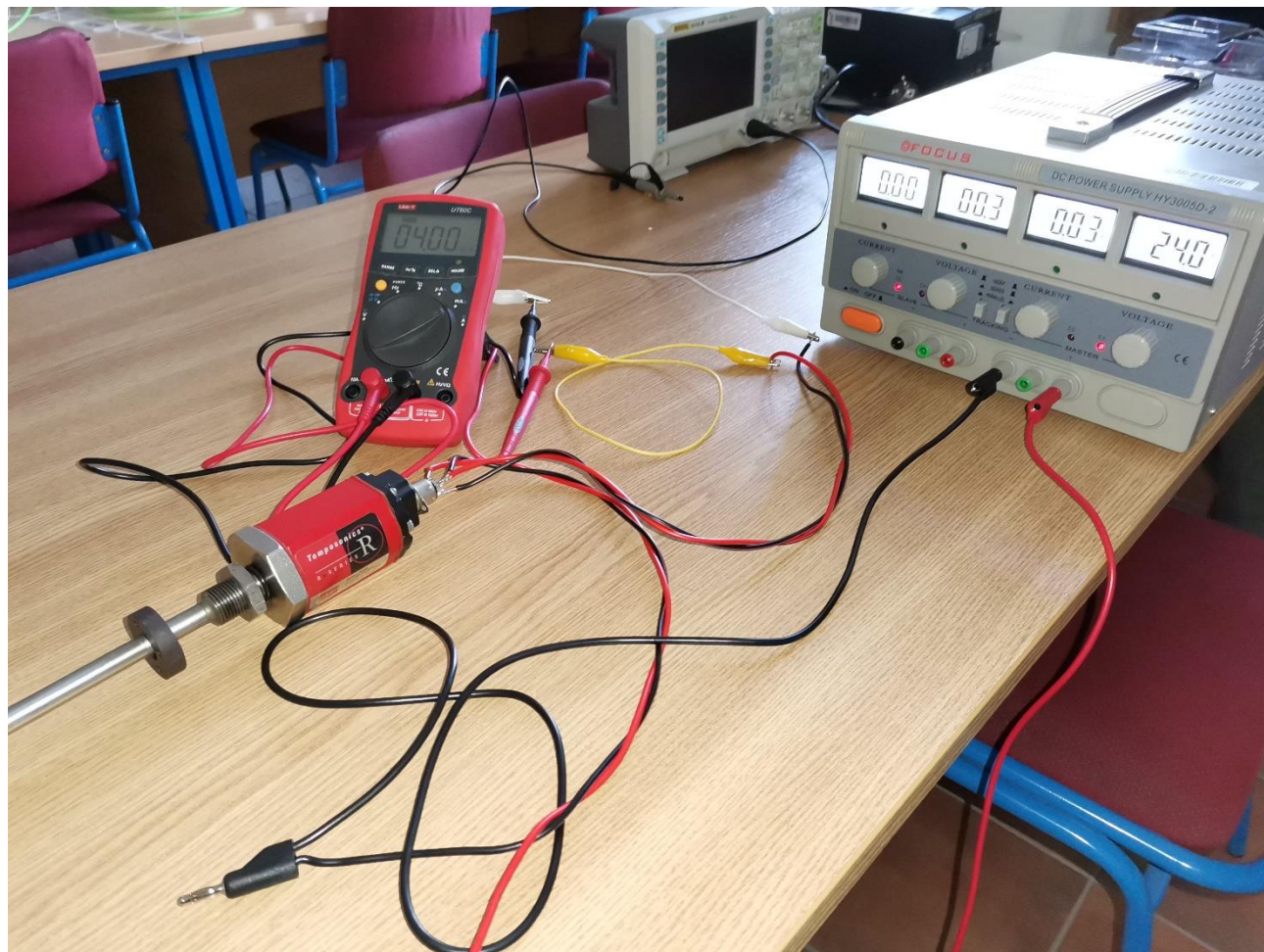
Slika 4.2. Mjerenje izlazne vrijednosti struje pomicanjem magnetnog prstena.
