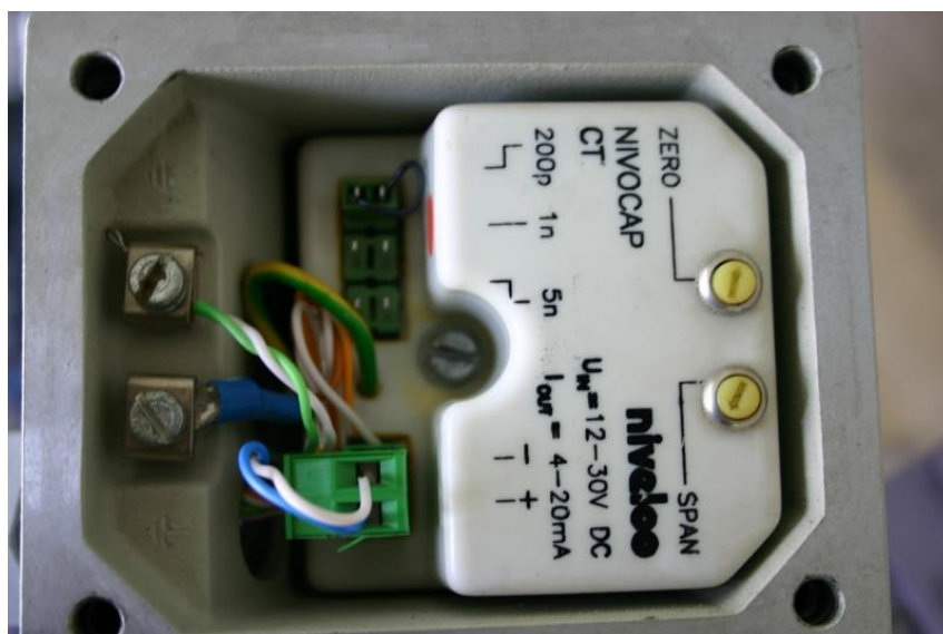
Slika P. 1.2. Unutrašnjost kućišta neispravnog mjernog člana.
