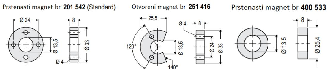
Slika 3.4. Izvedbe magneta mjernog člana Temposonics RH.
