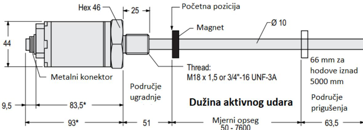
Slika 3.3. Temposonics RP/ Mjerni opseg: 50-7600mm.
