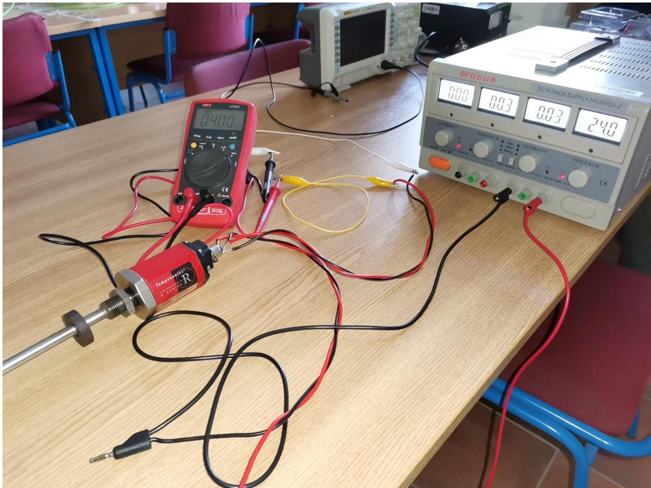
Slika 4.2. Mjerenje izlazne vrijednosti struje pomicanjem magnetnog prstena.
