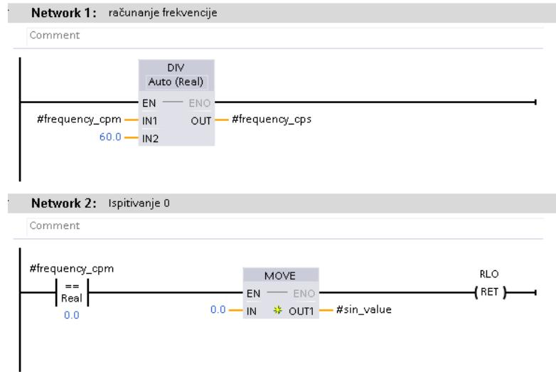
Slika 3.16. Prebacivanje frekvencije u prikladanu mernu jedinicu i paziti na dijeljenje s 0
