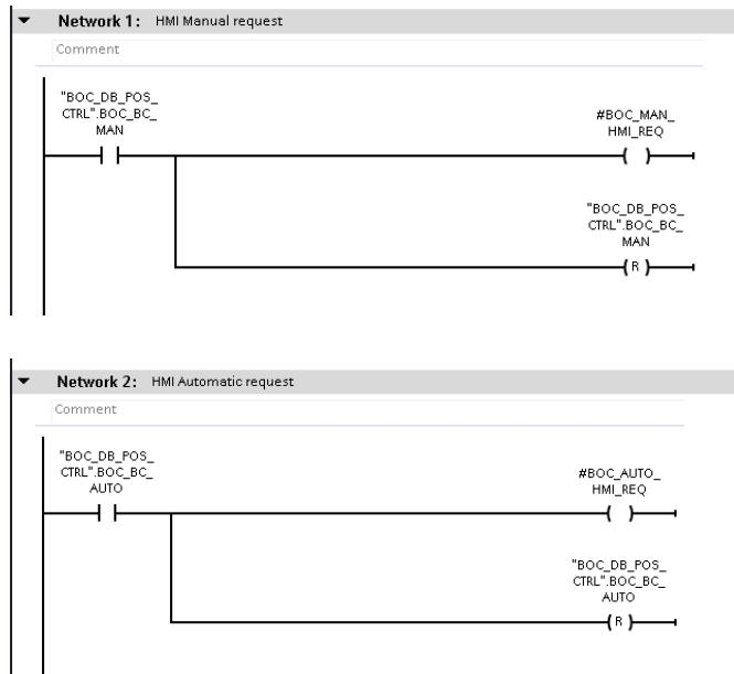
**Slika 3.1.** Zahtjev za ručni i automatski način rada
