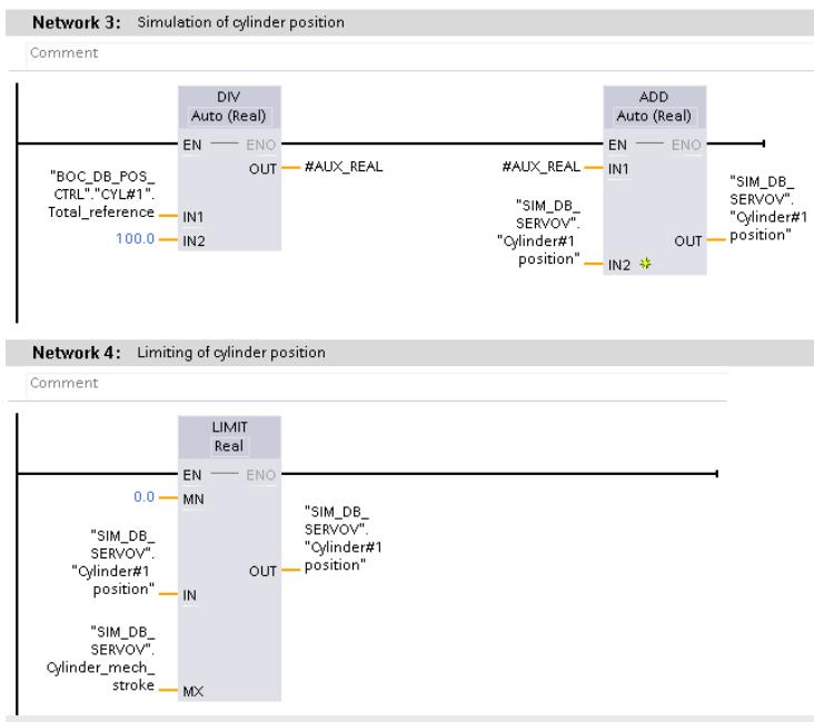
Slika 3.25. Funkcija za pretvaranje referentne vrijednosti servoventila u pomak cilindra i ograničavanje pomaka cilindra
