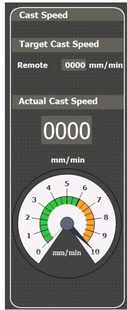
Slika 3.28. Ciljna i trenutna brzina lijevanja
