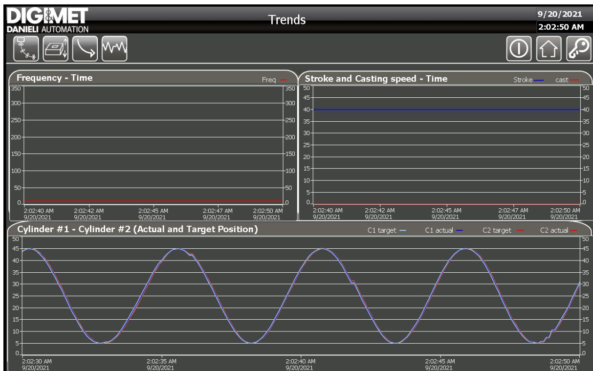
Slika 4.1. Ručni način rada – sinusni signal
