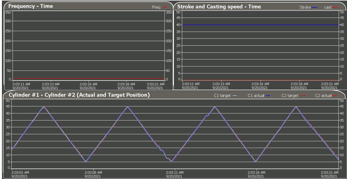
**Slika 4.2.** Ručni način rada – trokutati signal
