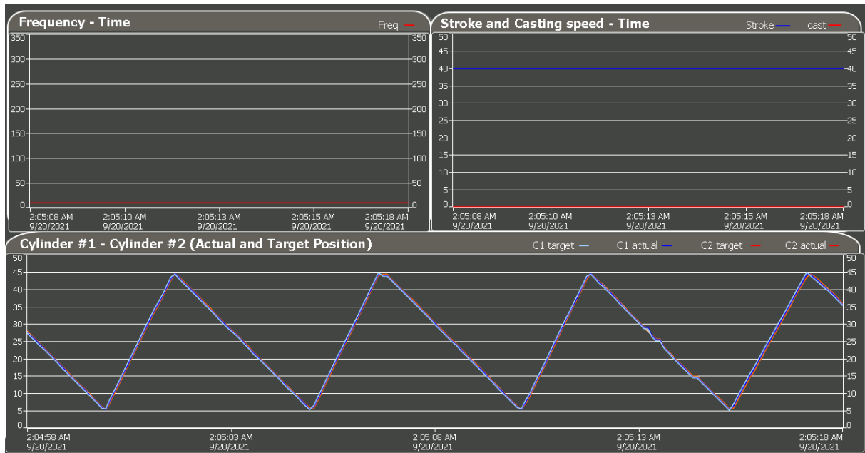
Slika 4.4. Ručni način rada – asimetrični trokutasti signal
