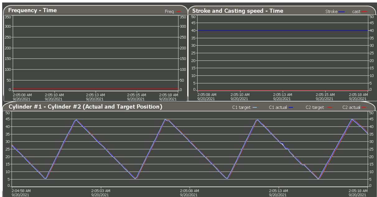
Slika 4.4. Ručni način rada – asimetrični trokutasti signal
