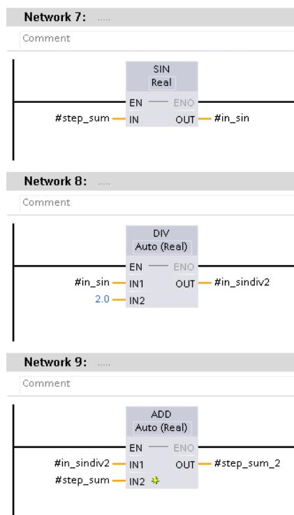
**Slika 3.20.** Dodatno računanje za asimetrični sinusni signal
