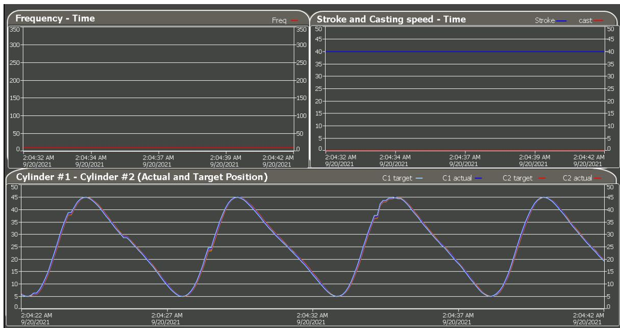
**Slika 4.3.** Ručni način rada – asimetrični sinusni signal
