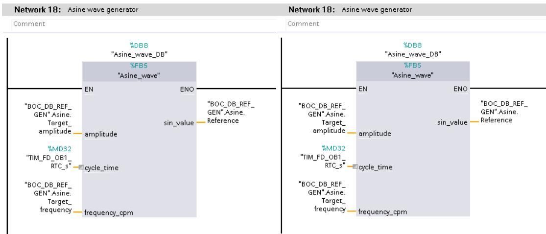
**Slika 3.6.** Pozivi funkcija sinusnog, trokustastog, asimetričnog sinusnog i asimetričnog trokustastog signala
