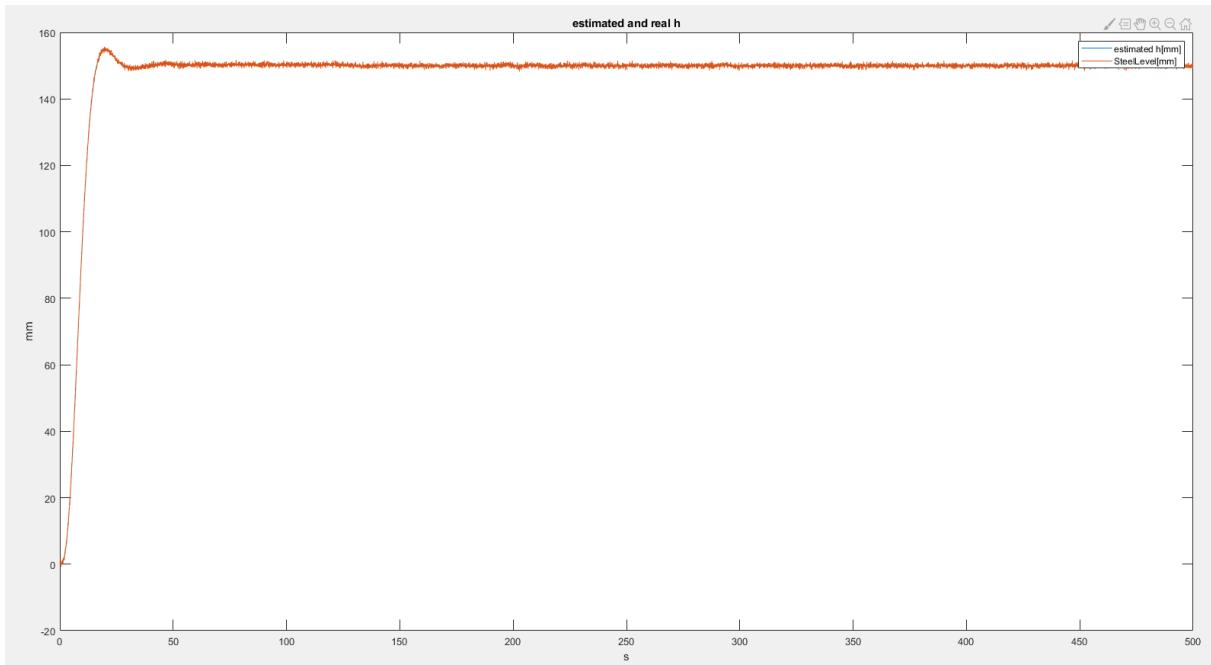
*Slika 4.14. Usporedba estimirane razine čelika s mjerom*
