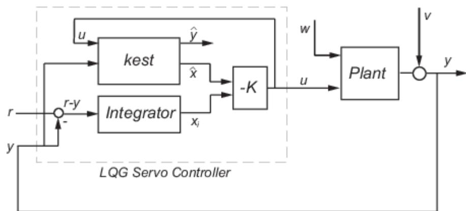
Slika 3.5. struktura LQG regulatora s integralnim djelovanjem [14]
