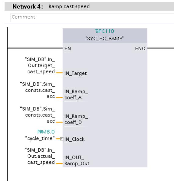
Slika 5.3. Rampiranje vrijednosti brzine lijevanja čelika
