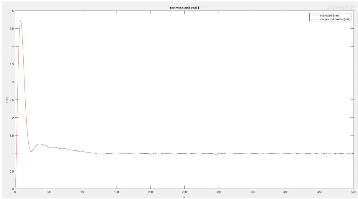
Slika 4.16. Usporedba estimirane i mjerene pozicije čepne motke
