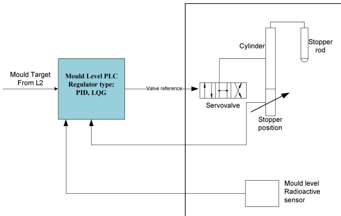
*Slika 3.2. Blok diagram upravljanja razinom čelika*
