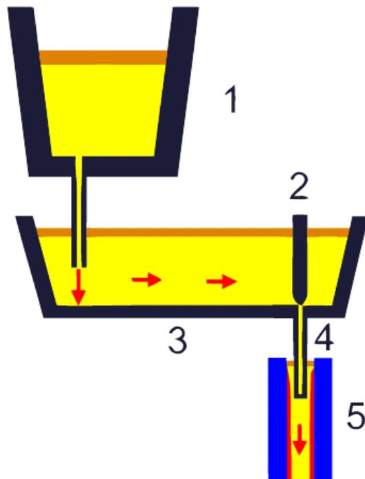
*Slika 2.4.: lijevanje čelika iz razdjelnika u kokilu s okomitom češnom motkom[4]*
