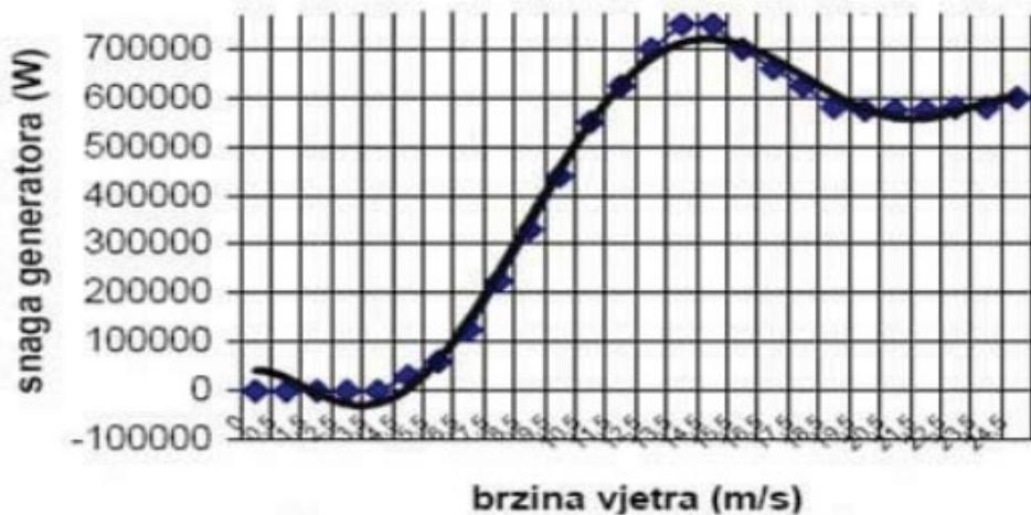
Slika 1: Ovisnost snage vjetrogeneratora o brzini vjetra [1]
