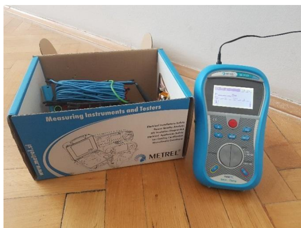
Slika 4.1. Mjerni instrument Metrel MI 3123
