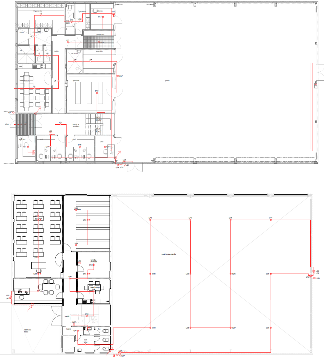
Slika 5.6. Tlocrt prizemlja i kata s cjelovitim prikazom sustava vatrodjave [18]
