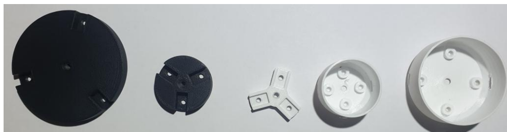
Slika 4.37. Različiti dizajni nosača lopatica (desni je najbliži finalnome dizajnu)
