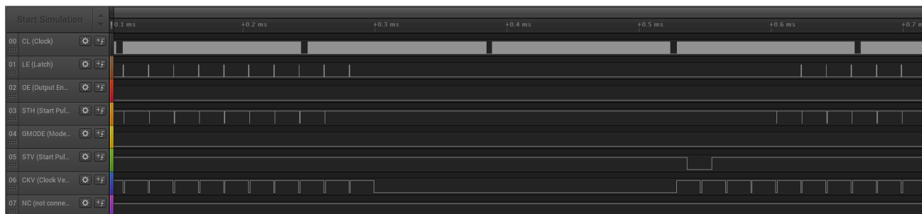
Slika 4.15. Ispravna sekvenca impulsa – čišćenje panela, završetak upisa zadnjeg reda i početak upisa novog okvira
