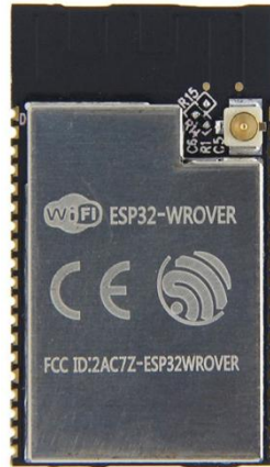
Slika 3.15. ESP32 WROVER modul [18]
