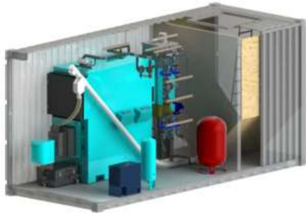
Slika 5.2. Kontejnerska kotlovnica na drvene pelete, [23]
