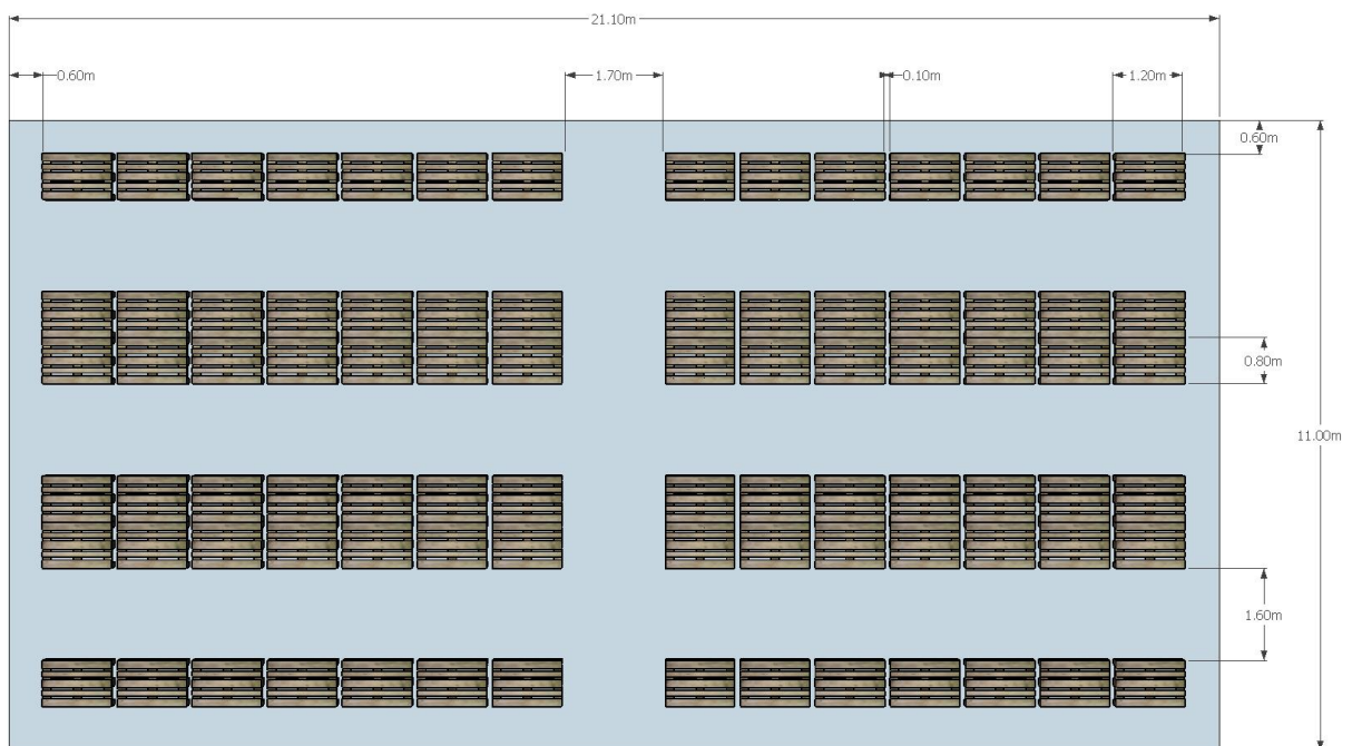
Slika 5.4: Tlocrtni prikaz i dimenzije skladišta.
