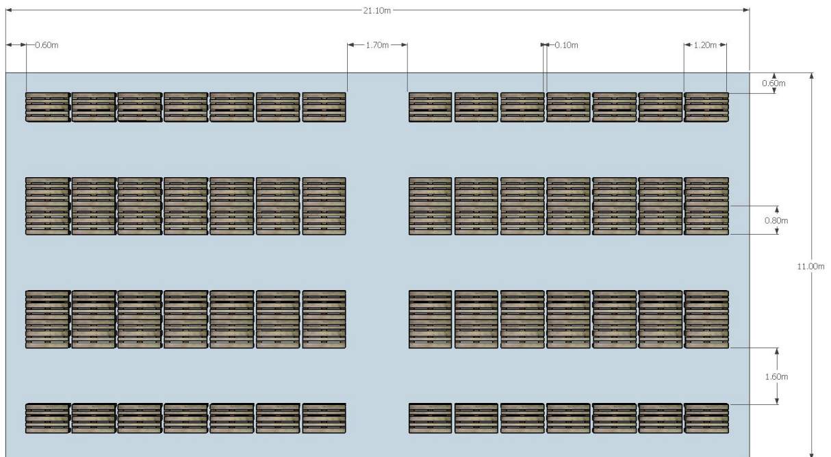
Slika 5.4: Tlocrtni prikaz i dimenzije skladišta.
