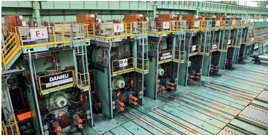
Sl. 2.3. Pogon za toplo valjanje[5].
