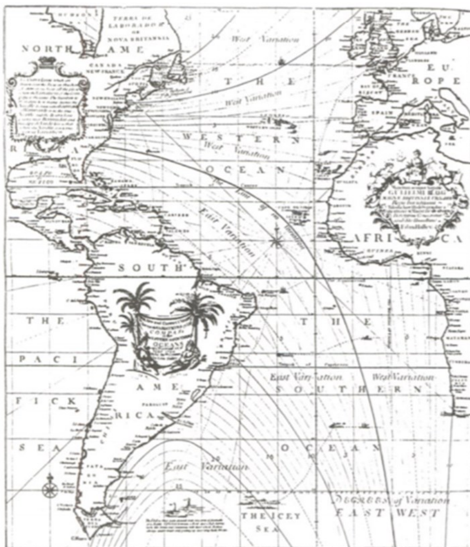
Sl. 2.1. Karta kontura magnetske deklinacije za područje Atlantskog oceana koju je napravio Edmund Halley. Deklinacije nisu točne zbog poteškoća u mjerenju geografskih dužina u vrijeme Halleyjeve plovidbe. [4]
