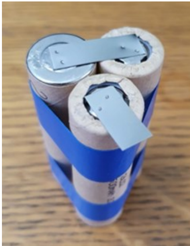
Slika 7.5.4. Zavareni plus i minus izvoda (a)
