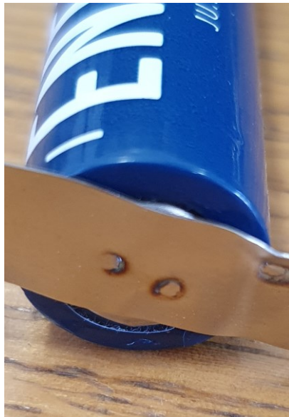
Slika 7.3.3. Spoj napravljen korištenem 6 pulseva i razina jakosti struje 4,5
