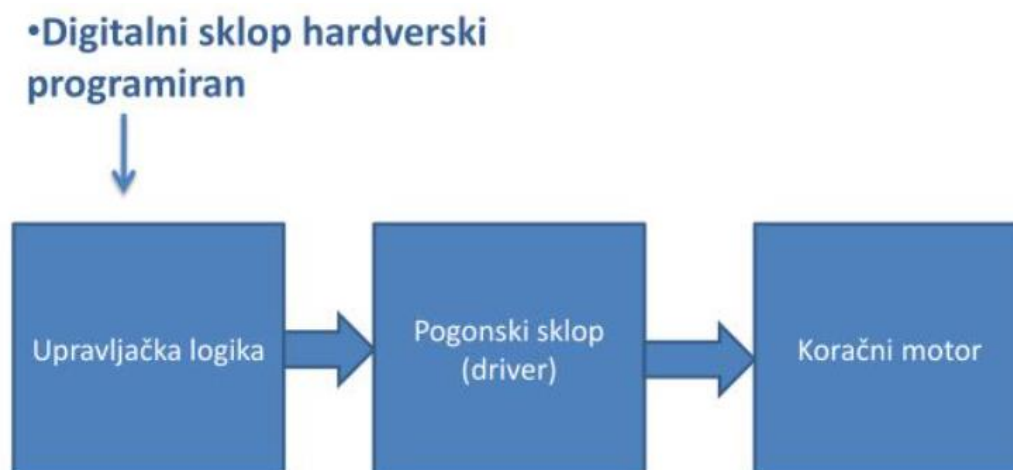
Slika 7.1. Blok prikaz koračnog pogona[10]
