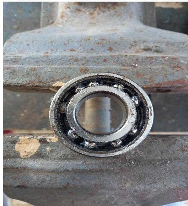
Slika 5.10: Namjerno oštečeni ležaj.
